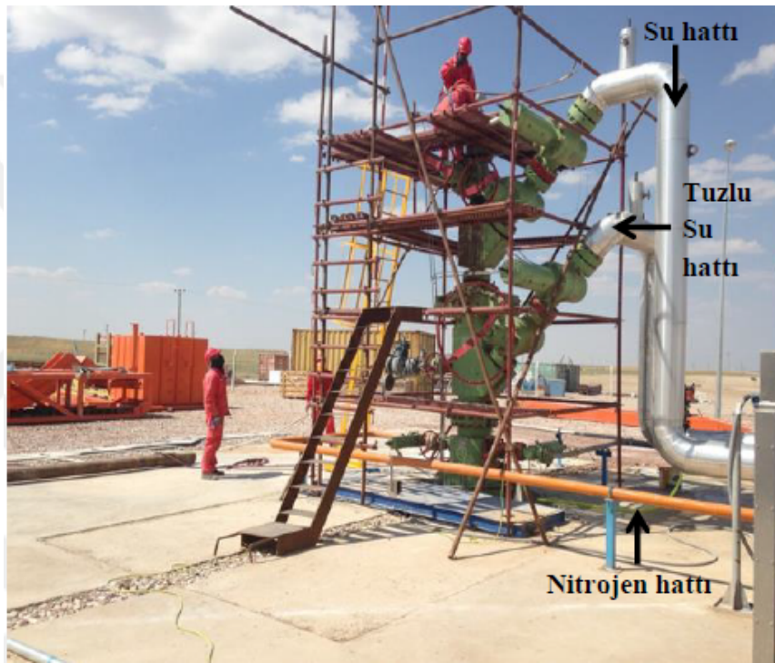
Şekil 2.32. Tuz eritme işleminde kullanılan tipik kuyu başı (Bektaşoğlu, 2016).
