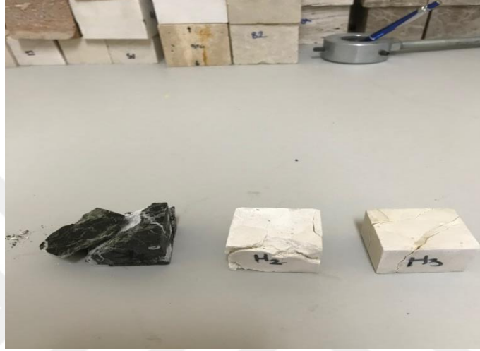
Şekil 4.13. Tuz kristallenmesi döngüleri sonucunda tahrip olan numunelerin görüntüsü
