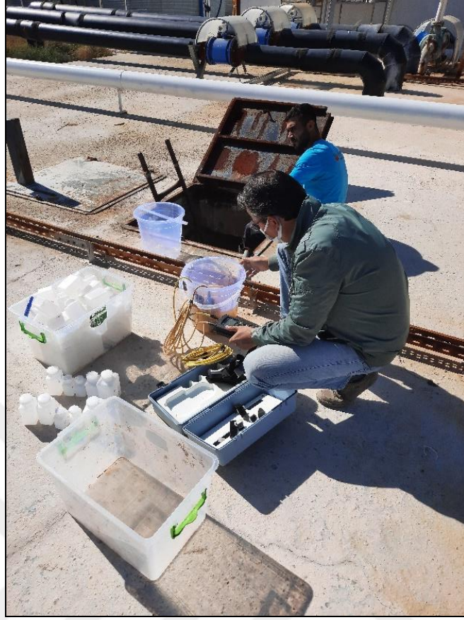
Şekil 3.1 T1 kodlu termal su örneğinin yerinde ölçümü.
