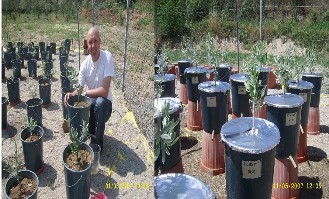
Şekil 3.6. Nethouse içine alınan saksıların alüminyum folyo ile kaplanması
