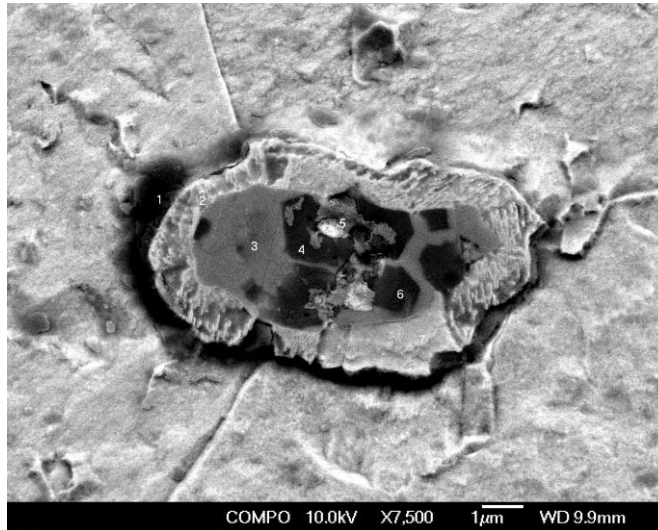
Şekil 4.17 : N4 numunesinde (1550°C-5dk-40 MPa) bulunan kompleks karbürün SEM görüntüsü.
