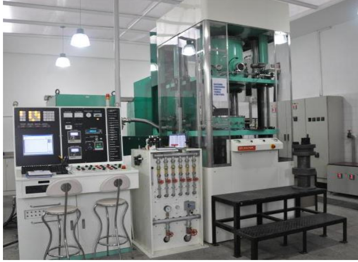
Şekil 3.2 : Numunelerin üretildiği SPS sistemi.
