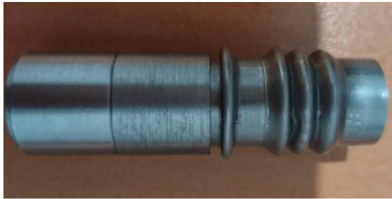
Şekil 4.15 ST-37 ile Üretimi Yapılan 3 Kıvrımlı Körüklü Boru
