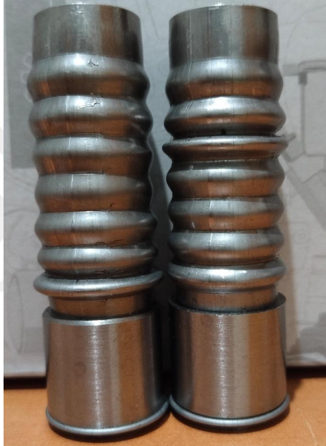
Şekil 4.16 ST-37 ile Üretimi Yapılan 7 Kıvrımlı Körüklü Boru
