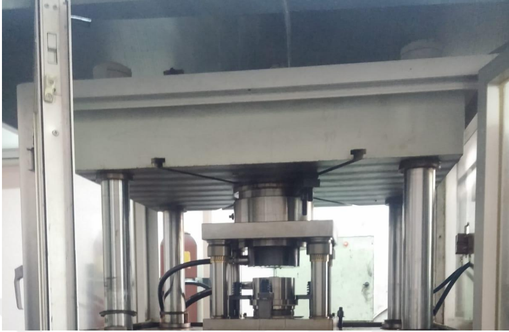
Şekil 3.13 Deneylerin Gerçekleştirileceği Hidro Şekillendirme Presi
