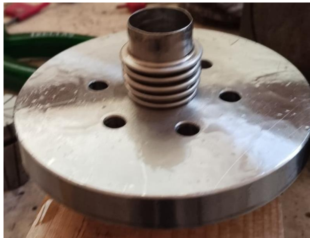
Şekil 4.19 Deney sonrası kalıptan çıkarılan AISI 316' dan üretilmiş numune
