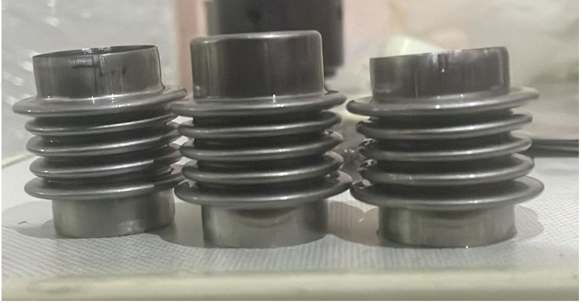
Şekil 4.17 Üretimi Yapılan 5 Kıvrımlı Körüklü Borular
