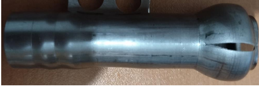
Şekil 4.14 ST-37 ile Üretimi Yapılan ve Yırtilan Boru
