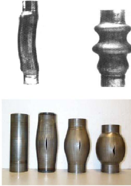
Şekil 2.6 Geometriden dolayı genişleyen parçalar
