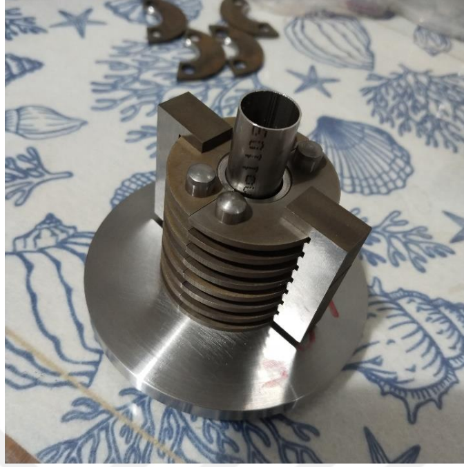
Şekil 3.12 Üretimi Yapılmış olan Körüklü Boru Hidro Şekillendirme Kalıbı
