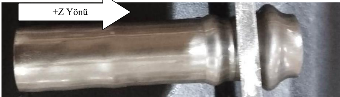
Şekil 4.13 Üretimi Yapılan Körüklü Boru
