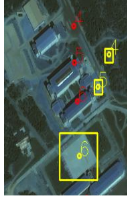
Şekil 3.11 : Hatalı bina adayları ve eşleştirildikleri gölge alanlar
