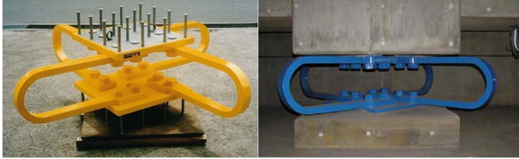
Şekil 3.4 : 4 adet U-şekilli damper (Jiao ve diğ, 2014).
