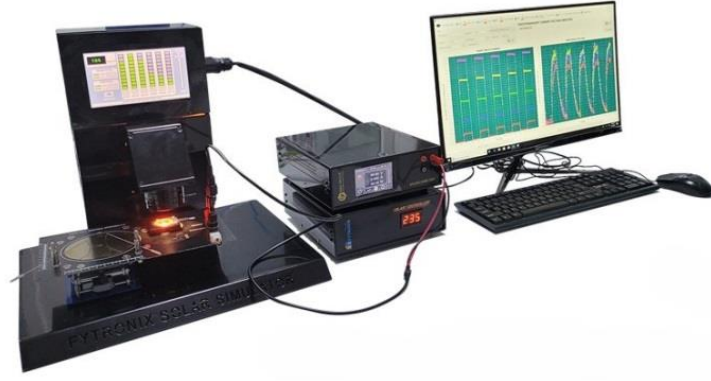
Şekil 3. 3. Hazırlanan Al/(ZnCdNiTiO 2 )/p-Si/Al Quaternary fonksiyonel Schottky tipi fotodiyotun akım-voltaj-ışık şiddeti (I-V-P) ölçüm sistemi.
