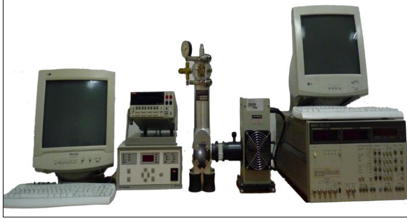
Şekil 3. 1. Hazırlanan Al/(ZnCdNiTiO 2 )/p-Si Quaternary fonksiyonel Schottky tipi fotodiyotun deneysel ölçümlerin gerçekleştirilmesinde kullanılan ölçüm ve kontrol cihazları.
