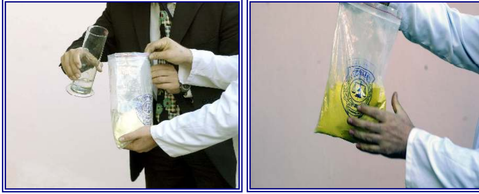
Şekil 23. 1 kg dişçi alçısı üzerine yaklaşık 370 ml. su ilave edildi ve bu bileşenler 4-5 dakika süreyle karıştırıldı.
