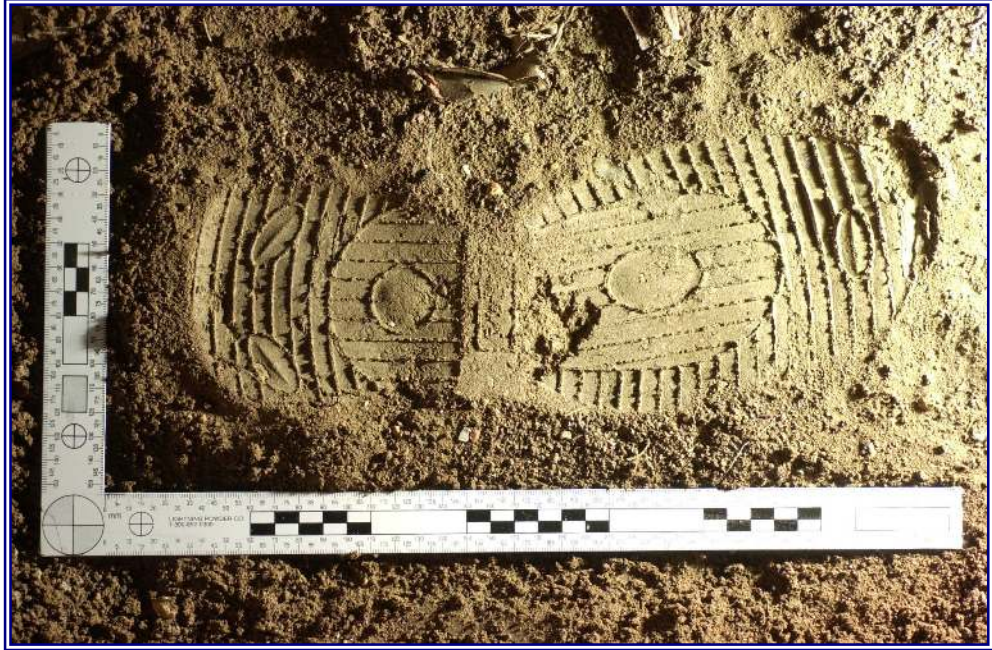
Şekil 19. Ayakkabı izinin bulunduğu bölge güneşliğinden arındırıldıktan sonra, izin sağ tarafından 30 derecelik yatay açıyla ışık verilmesi sonucunda oluşturulan, inceleme kalitesinde çekilmiş fotoğraf.
