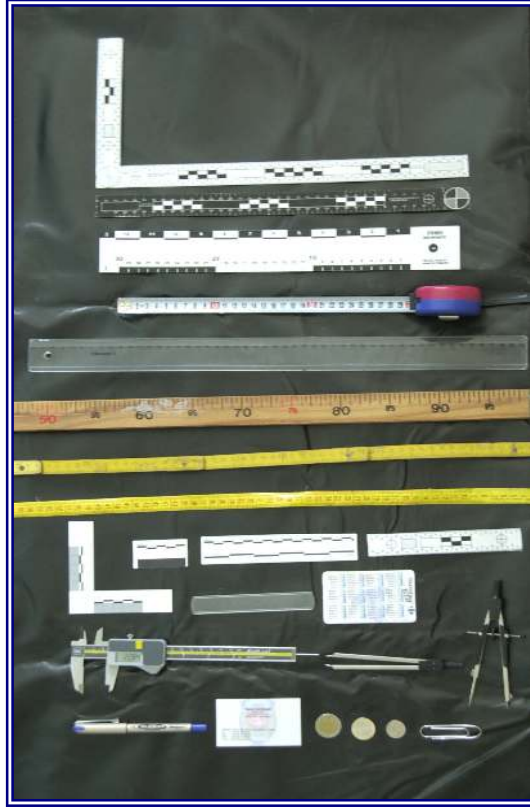
Şekil 11. Ayakkabı izleri için kullanılması gereken en uygun olandan uygun olmayanına göre yukarıdan aşağıya sıralanmış durumdaki çeşitli ölçü aletleri.
