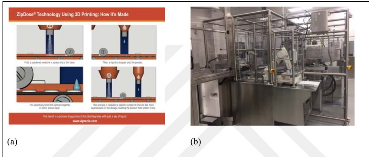
Şekil 2.13. Zipdose® teknolojisi görsel (a) Teknolojinin şematik gösterimi: (b) Aprecia firmasında kullanılan yazıcı
