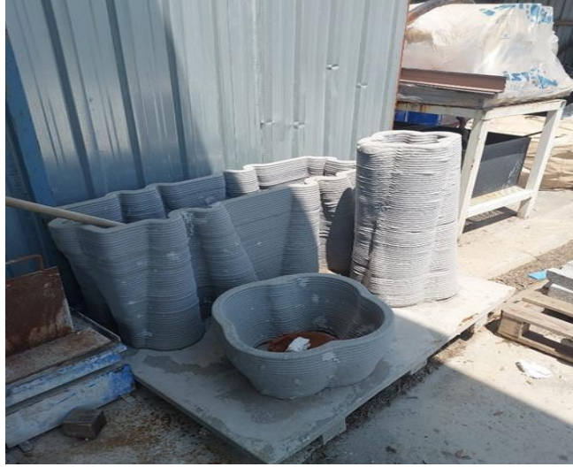
Şekil 2.1 Farklı Şekiller ile İmal Edilen Beton Baskılar
