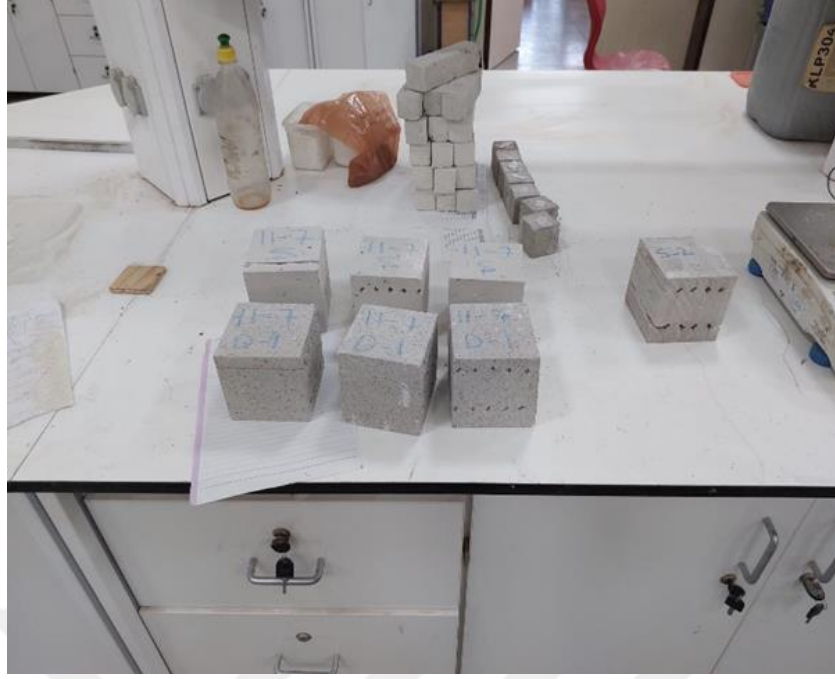
Şekil 3.16 Kesim İşlemi Sonrası İmal Edilen Bazı Numuneler (10x10x10 cm)
