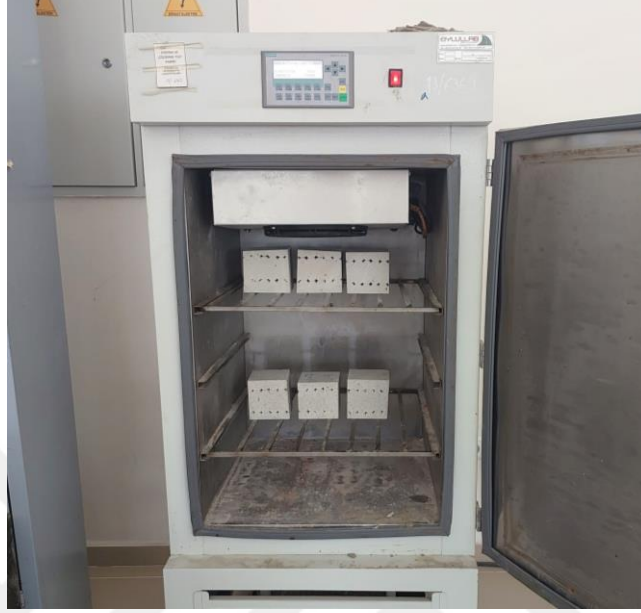
Şekil 3.19 Donma Çözünme Deneyi için Kullanılan İklimlendirme Kabini
