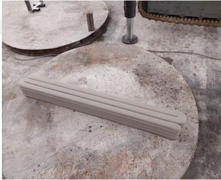
Şekil 3.15 3B Yazıcı ile İmal Edilen Beton Kiriş Numune (60x15x15 cm)
