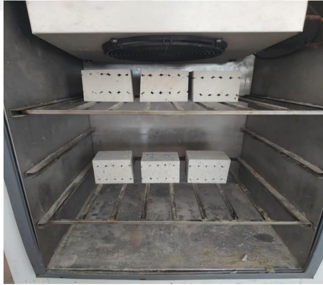
Şekil 3.20 İklimlendirme Kabini ve İçeri Numunelerin Yerleştirilmesi
