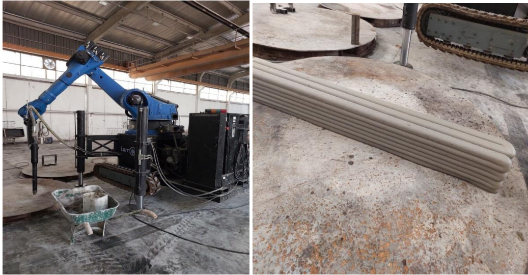
Şekil 2.2 ve 2.3 Üç Boyutlu Baskı Cihazı ve Üretilen Beton Kiriş
