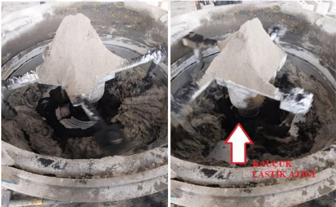
Şekil 3.8 İlgili Beton Harcının Hazne Mikserinde Karıştırılma İşlemi
