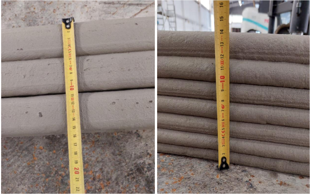
Şekil 3.10 İmalatı Tamamlanan Uzun Kirişin Boyut Ölçümü
