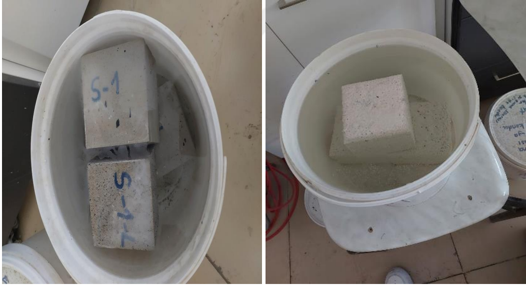
Şekil 3.21 ve 3.22 Sülfat ve Asit Deneyleri Sonucu Kırık Örnek Alınan Numuneler
