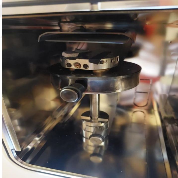
Şekil 3.26 SEM-EDX Öncesi İlgili Numunelerin Vakumlanması ve Kaplanması
