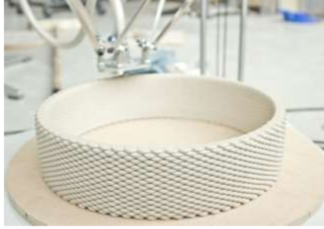
Görsel 2.4.1.2: Olivier Van Herpt, FDM Yöntemi Yazıcı ( http: 19 ).
