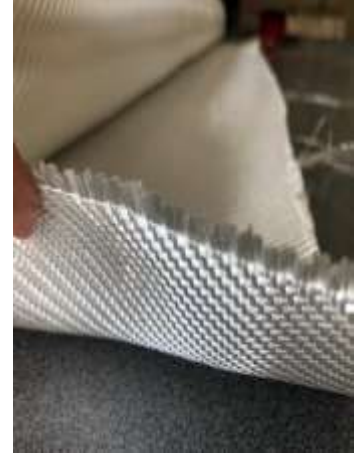
Şekil 5.7. Numune üretiminde kullanılan 2D dokuma cam fiber kumaşlar
