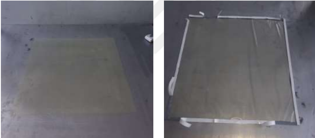
Şekil 5.14. Kontrol üniteli ısıtıcı masa yüzeyine ayırıcı film serilmesi ve çevresinin kağıt bantlarla sarılması
