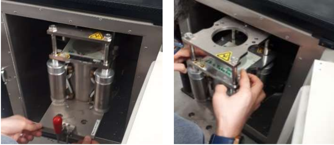
Şekil 5.26. Kompozit numunenin darbe cihazı haznesine yerleştirilmesi ve sabitlenmesi
