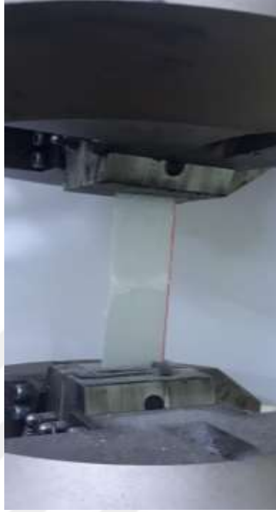
Şekil 5.22. Numunelerin çekme testi makinesine bağlanması
