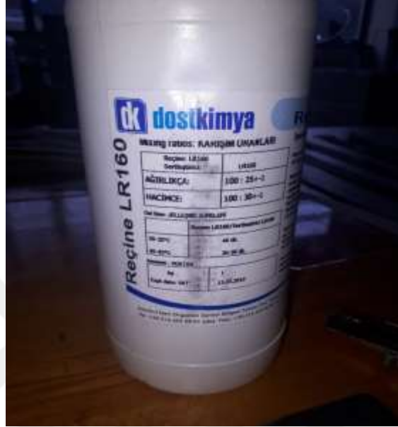
Şekil 5.12. Kompozit malzeme üretiminde kullanılan reçine ve sertleştirici
