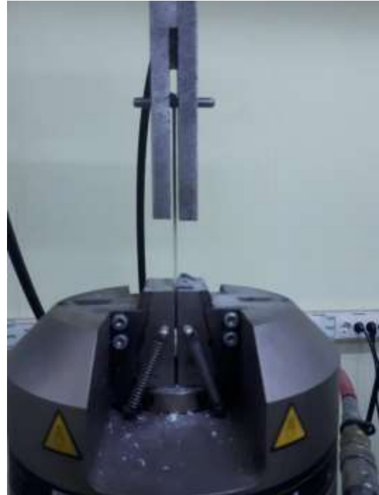
Şekil 5.23. Kompozit numunelerin pim bağlantı aparatı ile çekme testi cihazına bağlanması
