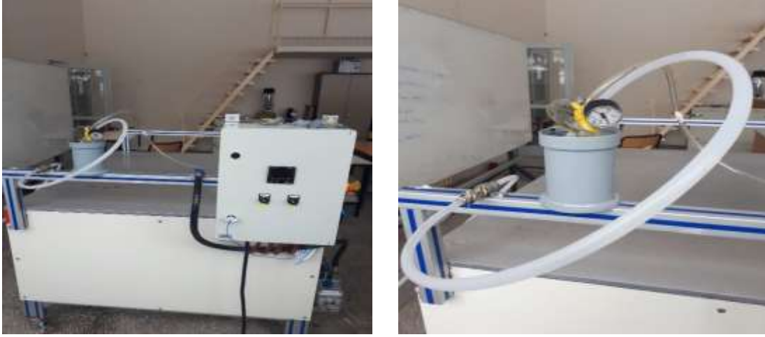
Şekil 5.13. Vakum infüzyon yönteminin gerçekleştirildiği kontrol panelli ısıtıcı masa
