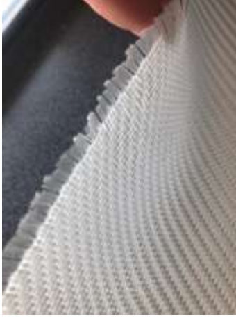
Şekil 5.7. Numune üretiminde kullanılan 2D dokuma cam fiber kumaşlar
