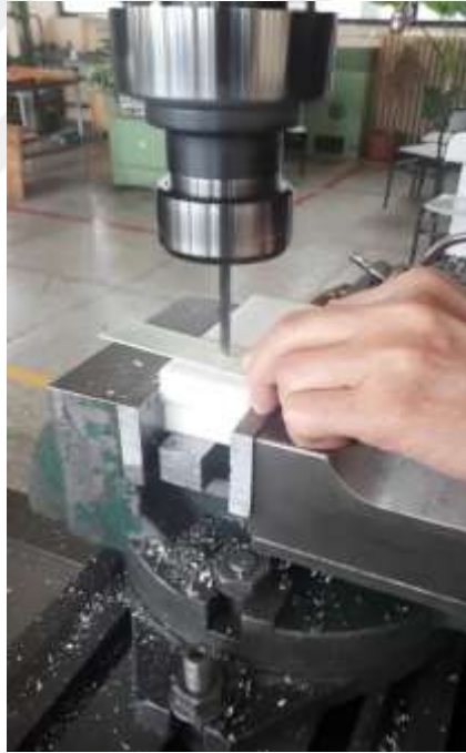
Şekil 5.20. Kompozit numunelerde pim deliği açma işlemi
