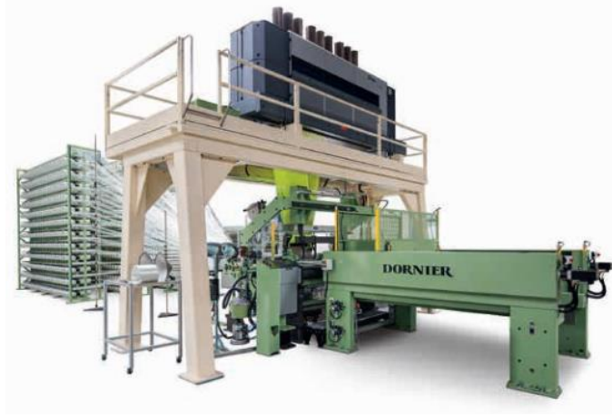
Şekil 1.6 3B kumaş üretimi yapabilen dokuma makinesi (Composite System, 2020)
