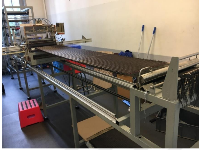
Şekil 2.1 Prototip dokuma makinesi (Gemtex Laboratuvarı/ ENSAIT) (Kişisel arşiv, 2021)
