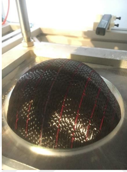
Şekil 2.22 Şekil alabilirlik testi uygulanan 3B çözgü interlok karbon kumaş (Kişisel arşiv, 2021)
