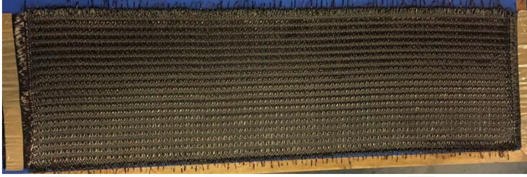
Şekil 2.11 Üretimi tamamlanan bir 3B çözümlü interlok karbon kumaş (Kişisel arşiv, 2021)
