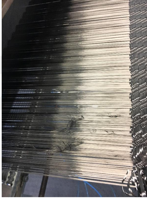
Şekil 2.10 Kumaş üretiminde karşılaşılan sürtünme kaynaklı kopuş sorunu (Kişisel arşiv, 2021)
