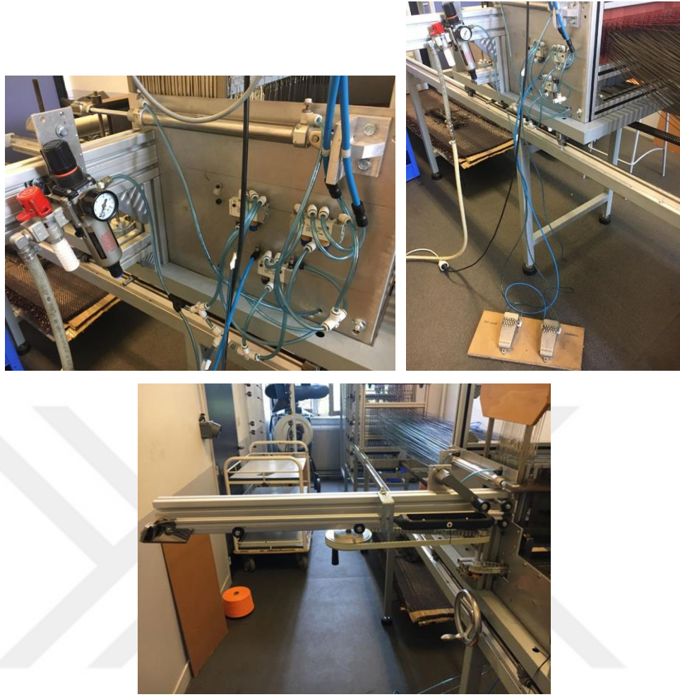
Şekil 2.5 Pnömatik sistem, pedallar ve atkı atma mekanizması (Gemtex Laboratuvarı/ ENSAIT) (Kişisel arşiv, 2021)
