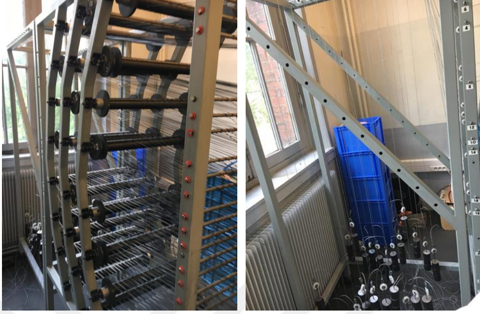
Şekil 2.6 Levent cağılığı ve levent ağırlıkları (Gemtex Laboratuvarı/ ENSAIT) (Kişisel arşiv, 2021)
