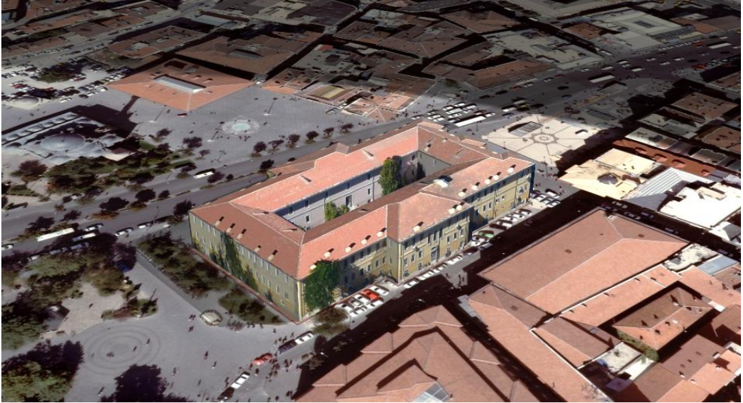
Şekil 2.27. Oblik hava fotoğrafı ile yüzeyleri kaplanmış LoD3 detay seviyesinde 3B bina modeli
