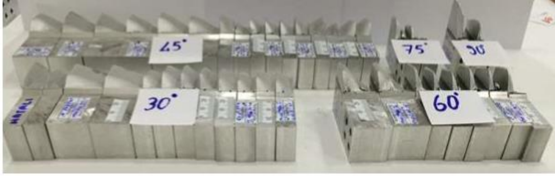
Şekil 4.22. da/dN testlerinde kullanılan numuneler [10].
