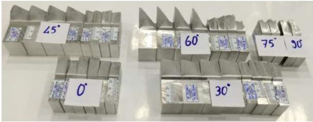
Şekil 4.14. Mod-I/III testleri sonrası numunelerin genel görünümü [10].
