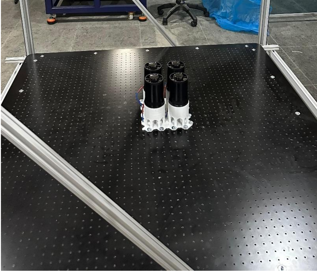
Şekil 38. Dört ısıtıcıdan oluşan ikinci dizinin ölçüm tablası üzerindeki görünümü
