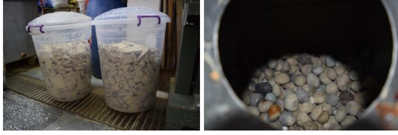
Görsel 3.15. Kurutulmuş şamotlu çamur ve bilyalı değirmen içindeki bilyalar
