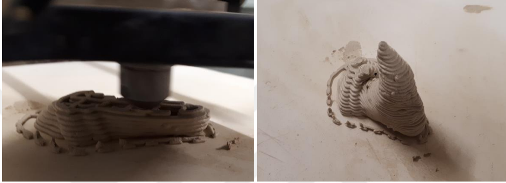
Görsel 3.21. Yazdırma işlemi (1), Yazdırma işlemi bitmiş seramik yaş bünye (2)
