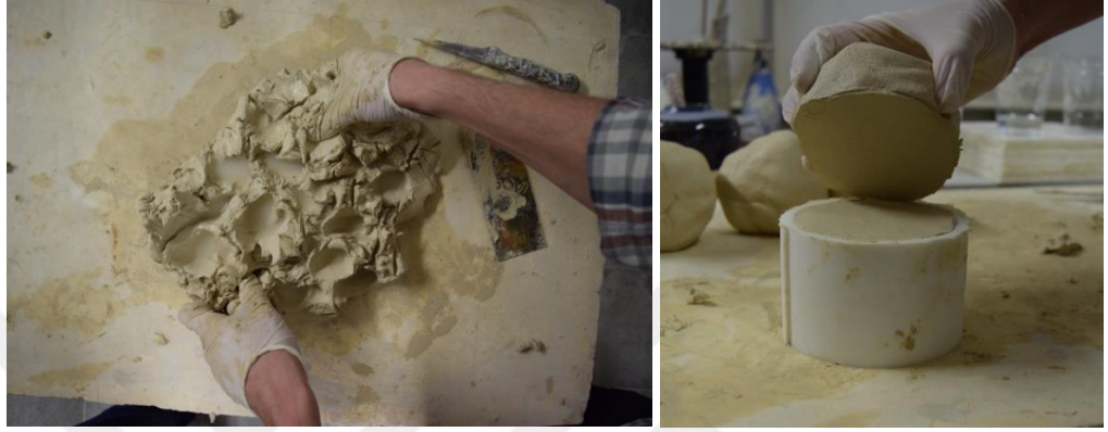
Görsel 3.18. Su katılmış çamurun yoğrulma işlemi başlangıcı (1), Silikon kalıp içine bastırılmış çamurun fazlalığının misina ile kesilmesi (2)
