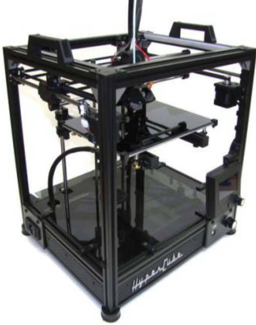
Şekil 3.6. Corexy tipi FDM çok boyutlu yazıcı örneği [56].
