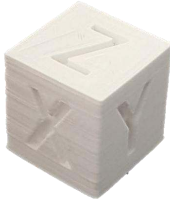
Şekil 5.12. FDM 1 NO 200 \mu\text{m} PLA yüzey pürüzlülüğü deneyi numunesi görüntüsü.
