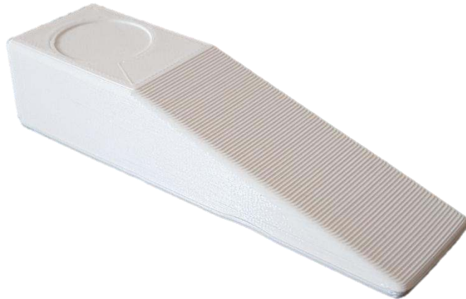
Şekil 5.33. FDM 1 NO PLA %50 destek kayıpları deneyi numunesi görüntüsü.
