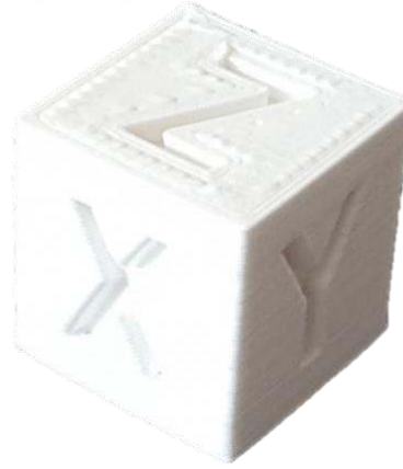
Şekil 5.16. FDM 1 NO 300 \mu\text{m} PLA yüzey pürüzlülüğü deneyi numunesi görüntüsü.
