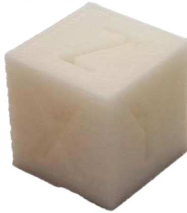
Şekil 5.8. FDM 1 NO 300 \mu\text{m} ABS yüzey pürüzlülüğü deneyi numunesi görüntüsü.
