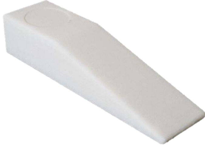
Şekil 5.38. 3 NO %20 destek kayıpları deneyi numunesi görüntüsü.
