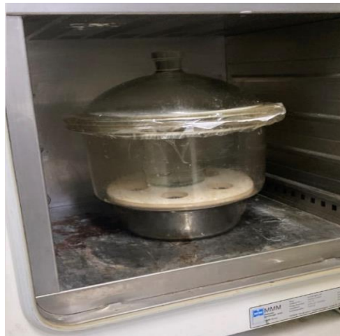
Şekil 3.3. Cam desikatör ile etüv içerisinde doku iskelelerinin çapraz bağlama işleminin yapılması.
