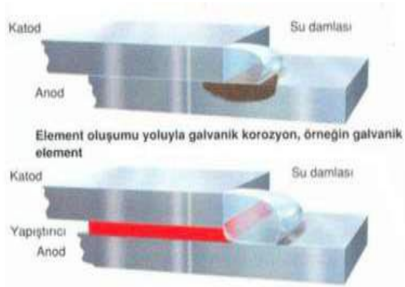
Şekil.1.1 İki farklı malzemenin galvanik korozyonu oluşturmaları (Demir,2016)
