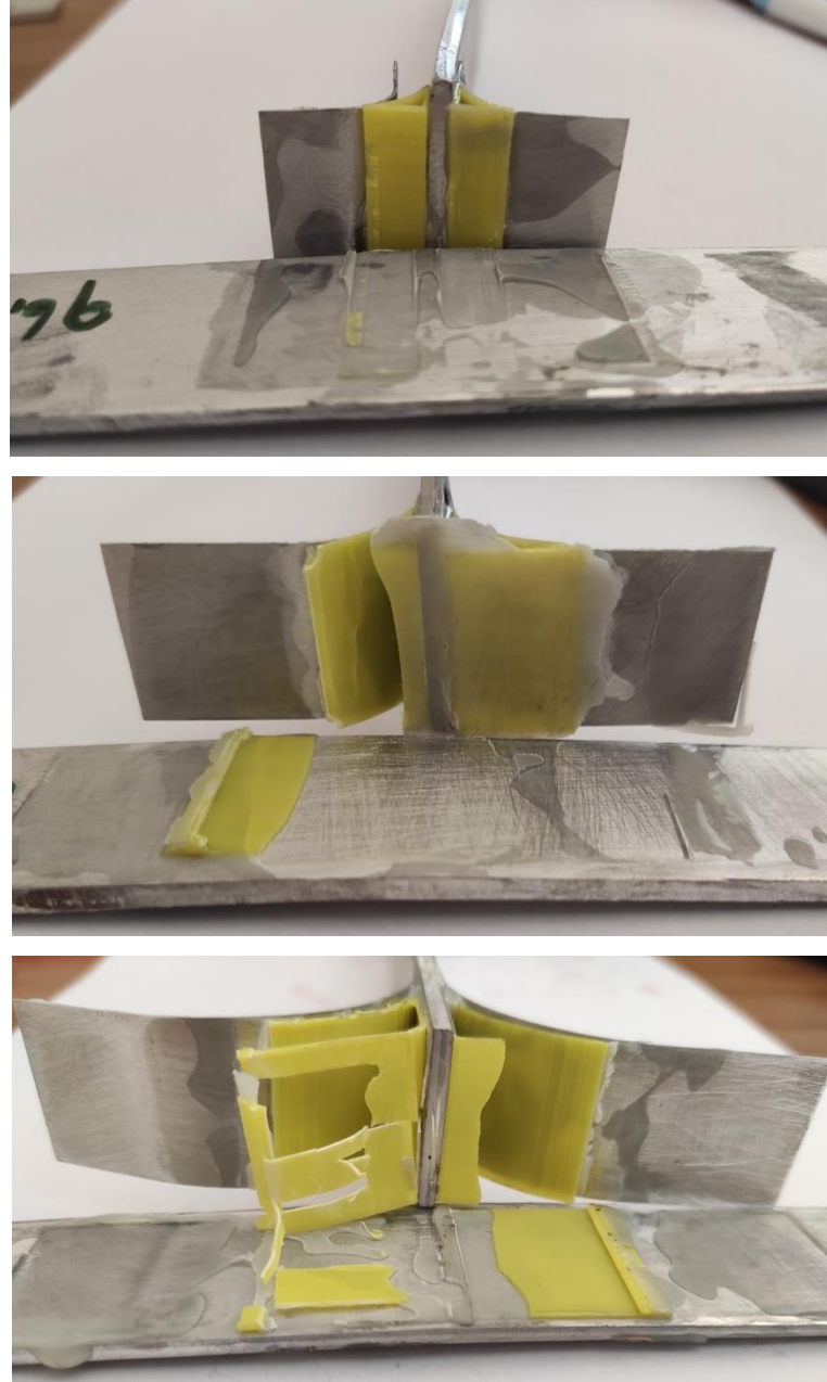
Şekil 4.12 0.25 mm duvar kalınlığına sahip içi boş takviye malzemesi kullanılan numunelerin hasar yüzeyleri
