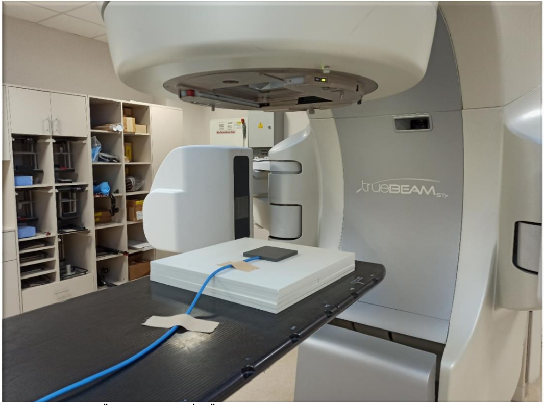
Şekil 16 : Deneysel Ölçüm Düzeneği (İlk Ölçüm Sadece Adaptör Levha)
