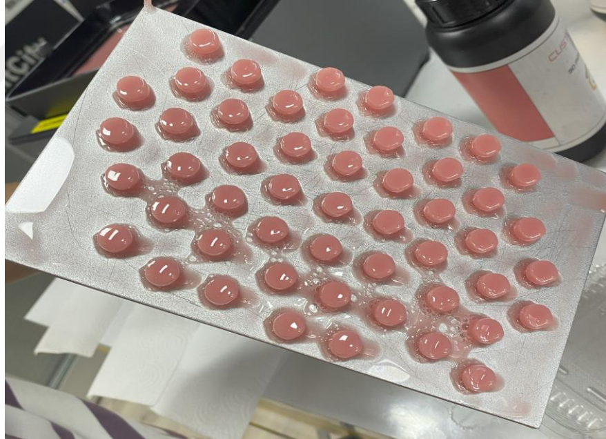
Şekil 3.17. Üretim platformu ve protez kaide örnekleri
