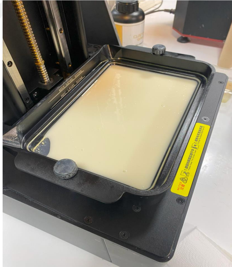
Şekil 3.7. Yapay diş reçinesinin tankın içine yerleştirilmesi
