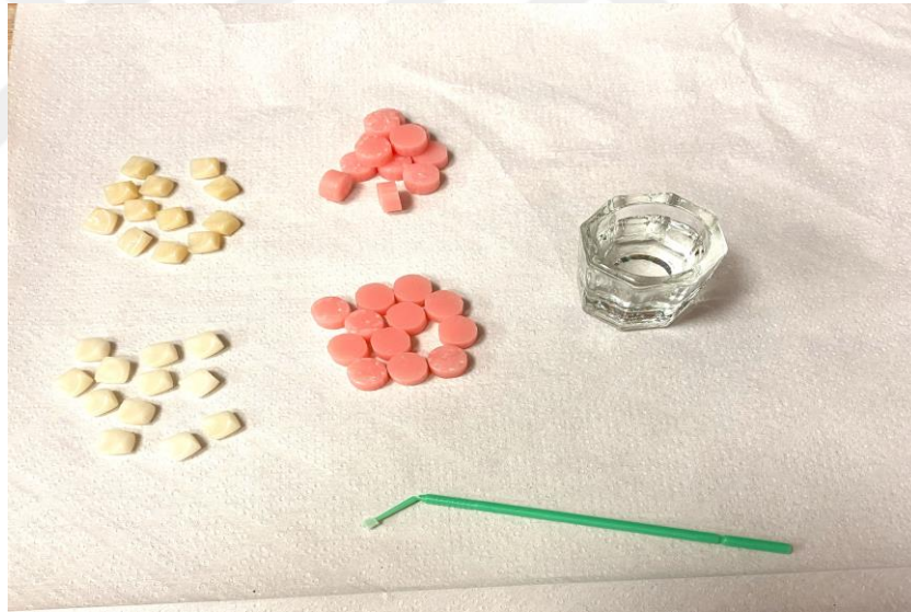
Şekil 3.22. Örneklere MMA uygulaması
