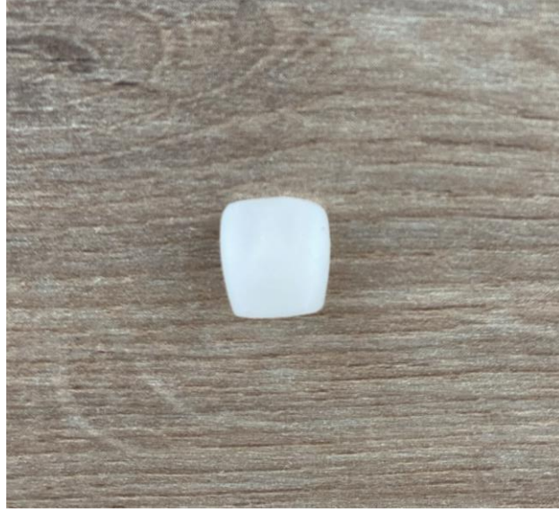
Şekil 3.12. 3B yazıcıyla üretilmiş yapay diş örneği önden görüntüsü
