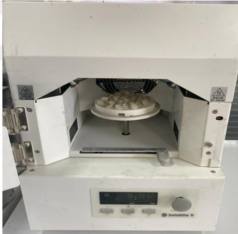
Şekil 3.11. Diş örneklerinin son kürleme için UV fırına yerleştirilmesi
