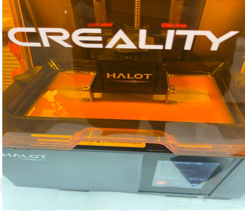
Şekil 3.16. 3B yazıcıda protez kaide örneklerinin üretimi
