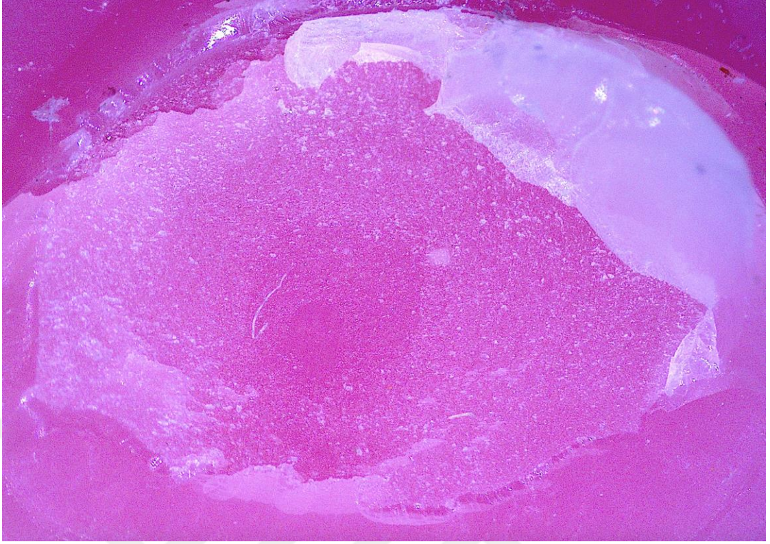
Şekil 3.30. Karışık tip kopma stereomikroskop görüntüsü
