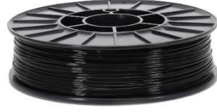
Şekil 4.1. MWCNT/ABS nanokompozit (750 g) filament formunda ABS makarası üzerine sarılmıştır.
