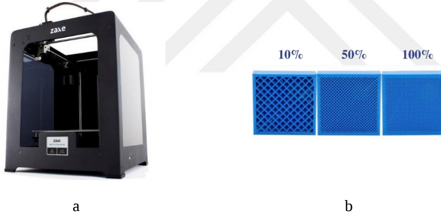
Şekil 4.3. FDM tipi üç boyutlu yazıcı (a), farklı doluluk oranları (b).
