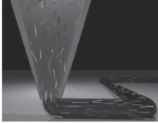
Şekil 1.2. Nano kompozit malzemenin 3B yazıcı memesinden akışının şeması
