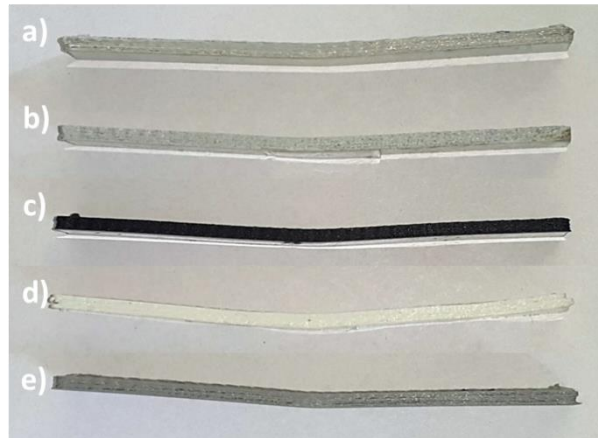
Şekil 6.30. 3 nokta eğme testi sonrası numuneler; a) SiO 2 /ABS, b) Al/ABS, c) MWCNTs/ABS, d) katkısız-ABS, e) ZrB 2 /ABS.
