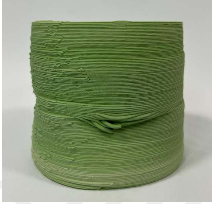
Resim 3.31. Toprağın Yeşili, Üç Boyutlu Yazıcı İle Şekillendirme, Yeşil Pigment Katkılı Porselen Çamuru, 3 mm Nozzle Uç, 1200°C
