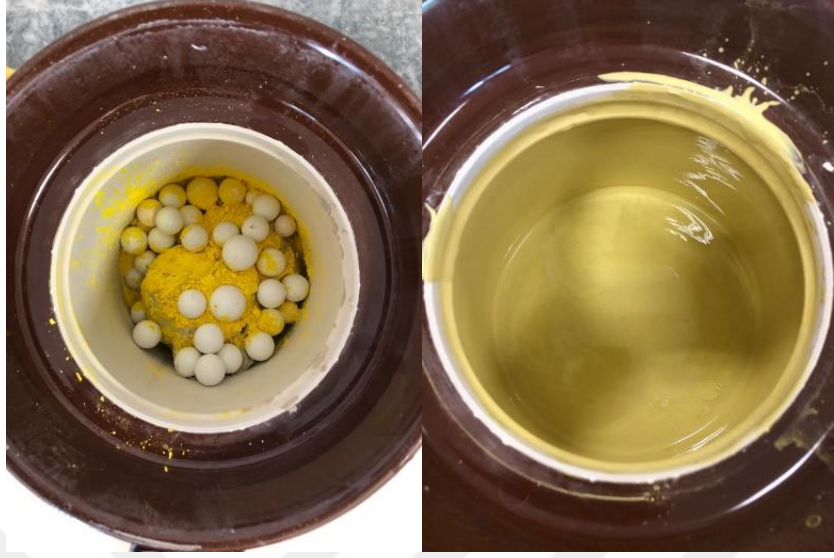
Resim 3.1. Renklendirilmiş Çamurun Hazırlık Aşaması
