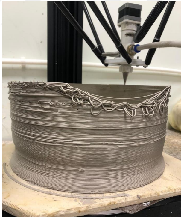
Resim 3.38. Üç Boyutlu Yazıcıyla Üretim Aşaması, FDM Yöntemi Kaynak: (Çil, 2025)
