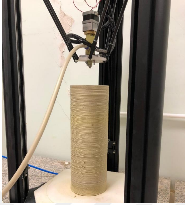
Resim 3.11. Üç Boyutlu Yazıcıyla Üretim Aşaması, FDM Yöntemi Kaynak: (Çil, 2025)
