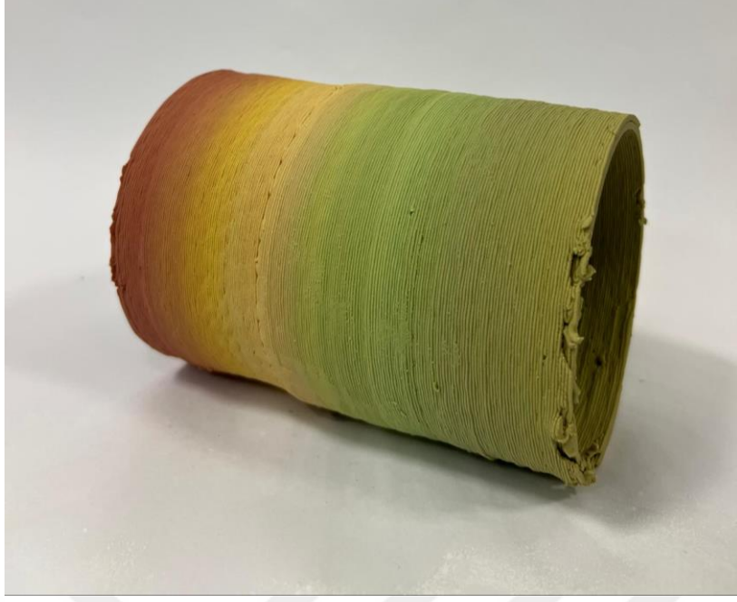
Resim 3.64. Sonbahar Kodları, Üç Boyutlu Yazıcı İle Şekillendirme, Sarı, Kırmızı ve Yeşil Pigment Katkılı Porselen Çamuru, 3 mm Nozzle Uç, 1200°C
