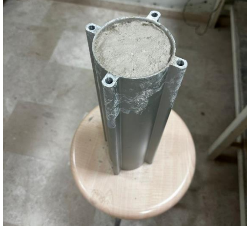
Resim 3.5. Çamurun Tank İçerisine Yerleştirilmesi
