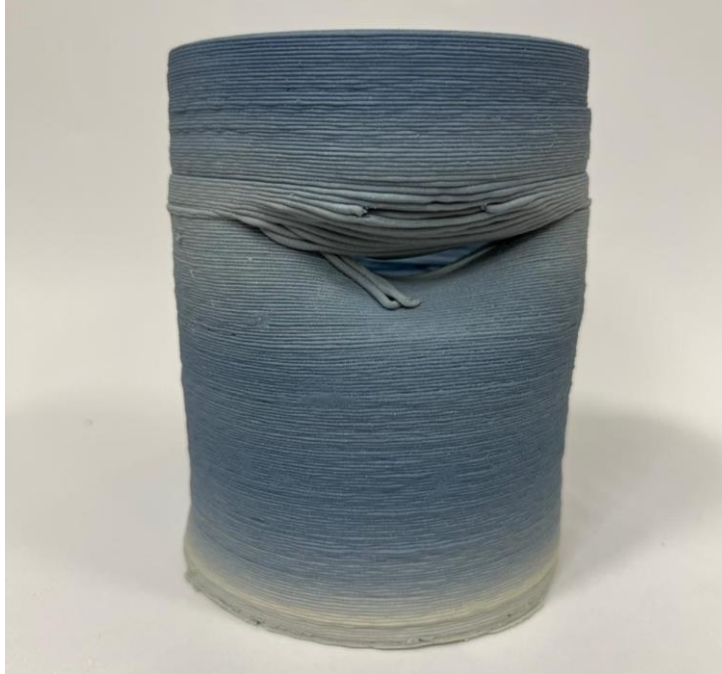
Resim 3.48. Kobalt Yankısı, Üç Boyutlu Yazıcı İle Şekillendirme, Kobalt Oksit Katkılı Porselen Çamuru, 3 mm Nozzle Uç, 1200°C
