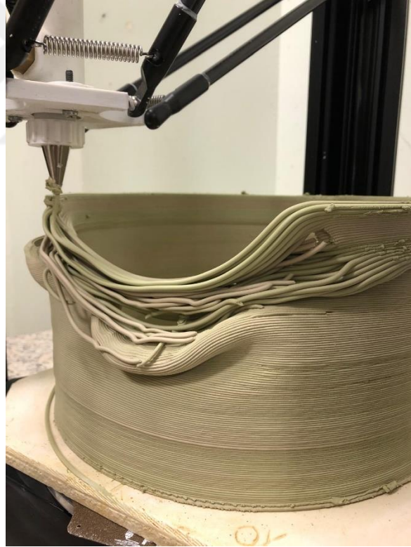
Resim 3.25. Üç Boyutlu Yazıcıyla Üretim Aşaması, FDM Yöntemi
