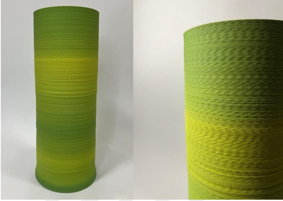
Resim 3.29. Toprağın Yeşili, Üç Boyutlu Yazıcı İle Şekillendirme, Yeşil Pigment Katkılı Porselen Çamuru, 3 mm Nozzle Uç, 1200°C
