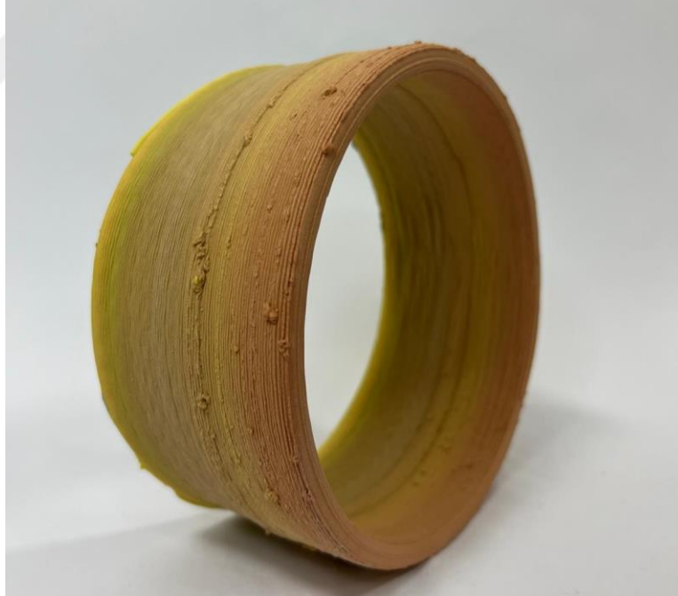
Resim 3.62. Sonbahar Kodları, Üç Boyutlu Yazıcı İle Şekillendirme, Sarı, Kırmızı ve Yeşil Pigment Katkılı Porselen Çamuru, 3 mm Nozzle Uç, 1200°C
