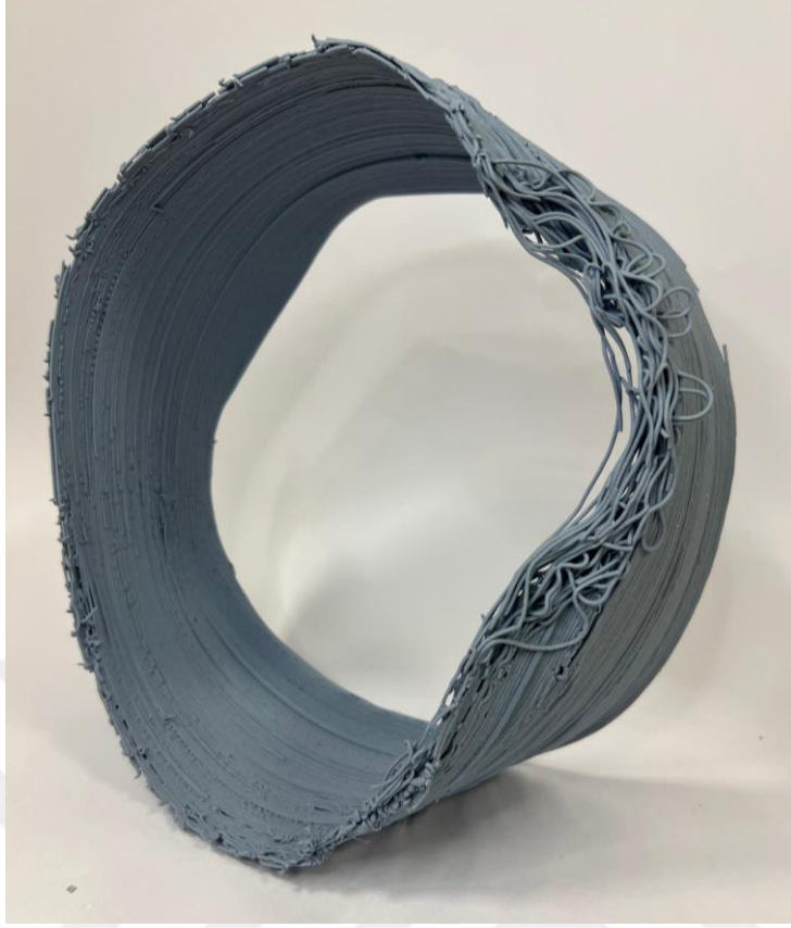
Resim 3.46. Kobalt Yankısı, Üç Boyutlu Yazıcı İle Şekillendirme Detay, Kobalt Oksit Katkılı Porselen Çamuru, 2 mm Nozzle Uç, 1200°C
