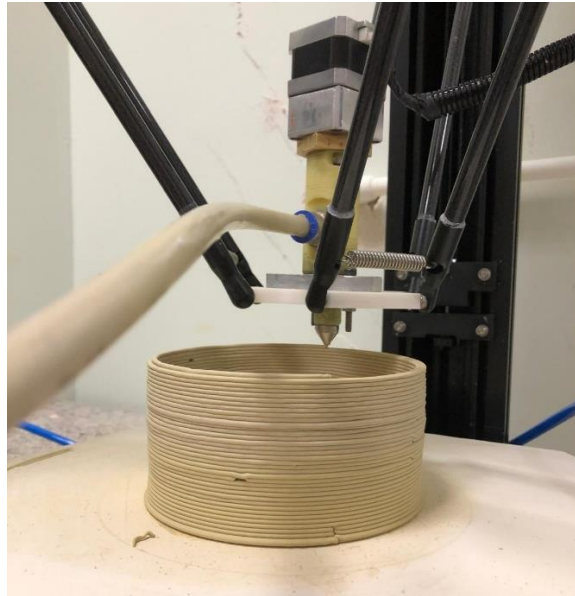
Resim 3.10. Üç Boyutlu Yazıcıyla Üretim Aşaması, FDM Yöntemi
