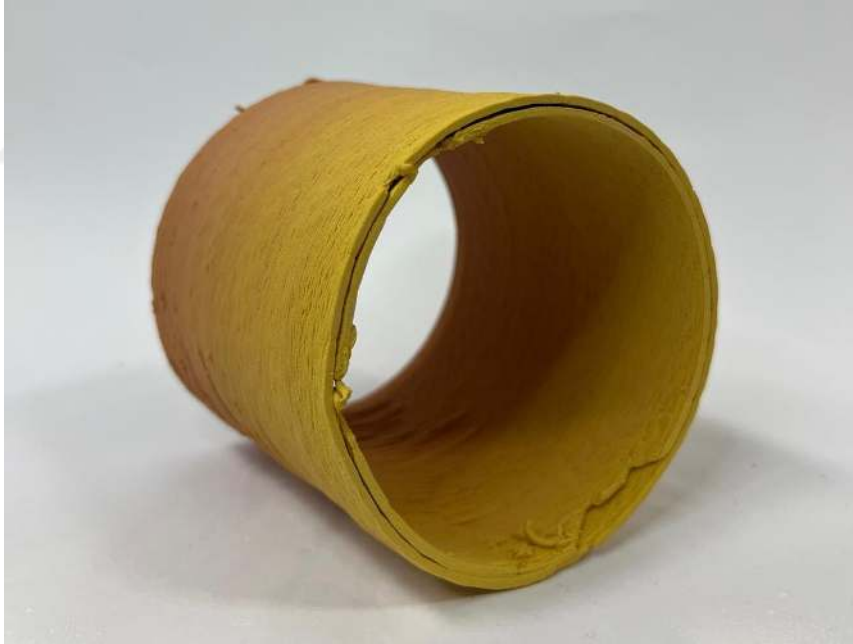
Resim 3.65. Sonbahar Kodları, Üç Boyutlu Yazıcı İle Şekillendirme, Sarı, Kırmızı ve Yeşil Pigment Katkılı Porselen Çamuru, 3 mm Nozzle Uç, 1200°C
