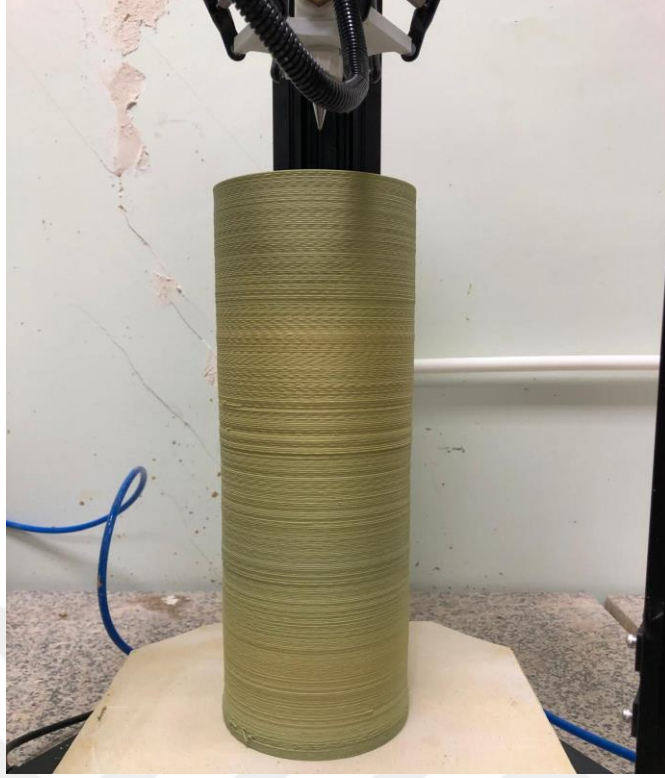
Resim 3.22. Üç Boyutlu Yazıcıyla Üretim Aşaması, FDM Yöntemi
