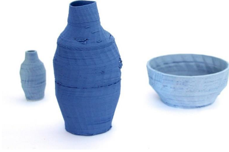
Resim 2.32. Üç Boyutlu Yazıcıda Şekillendirilmiş Renkli Porselen Baskı
