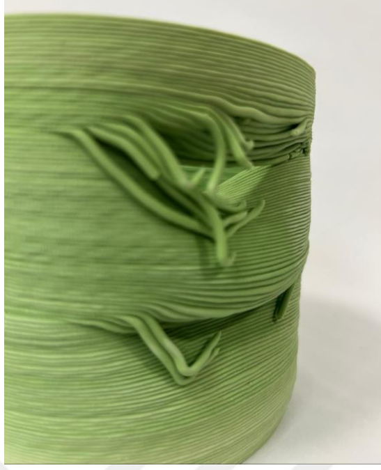
Resim 3.32. Toprağın Yeşili, Üç Boyutlu Yazıcı İle Şekillendirme, Yeşil Pigment Katkılı Porselen Çamuru, 3 mm Nozzle Uç, 1200°C
