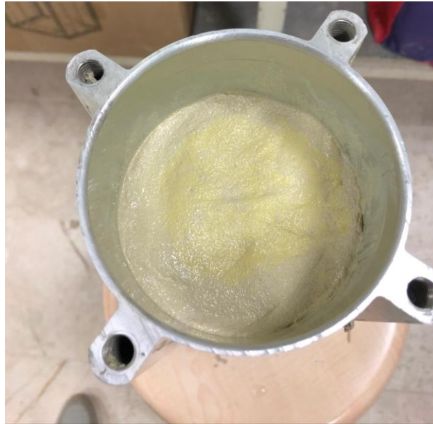
Resim 3.4. Çamurun Tank İçerisine Yerleştirilmesi
