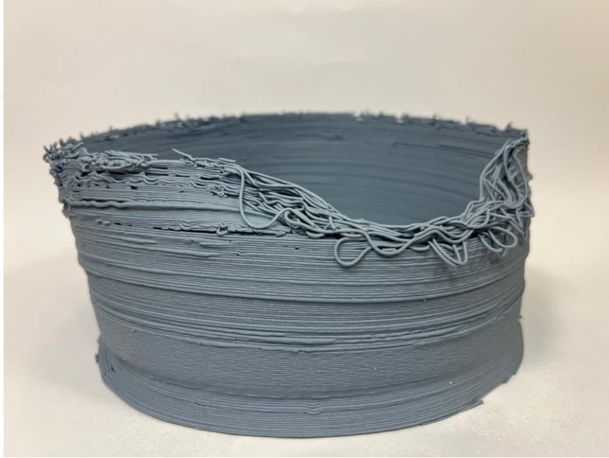
Resim 3.45. Kobalt Yankısı, Üç Boyutlu Yazıcı İle Şekillendirme, Kobalt Oksit Katkılı Porselen Çamuru, 2 mm Nozzle Uç, 1200°C
