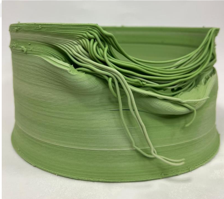
Resim 3.27. Toprağın Yeşili, Üç Boyutlu Yazıcı İle Şekillendirme, Yeşil Pigment Katkılı Porselen Çamuru, 3 mm Nozzle Uç, 1200°C
