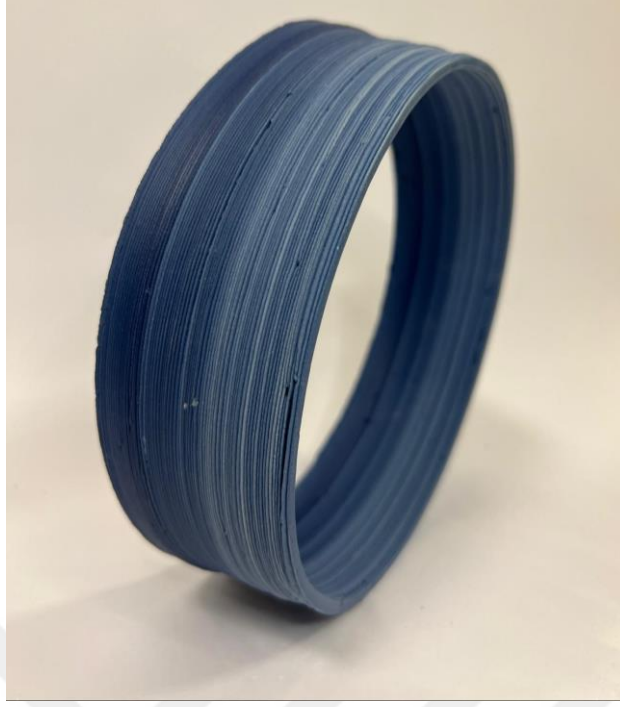
Resim 3.58. Kobalt Yankısı, Üç Boyutlu Yazıcı İle Şekillendirme, Kobalt Oksit Katkılı Porselen Çamuru, 2 mm Nozzle Uç, 1200°C
