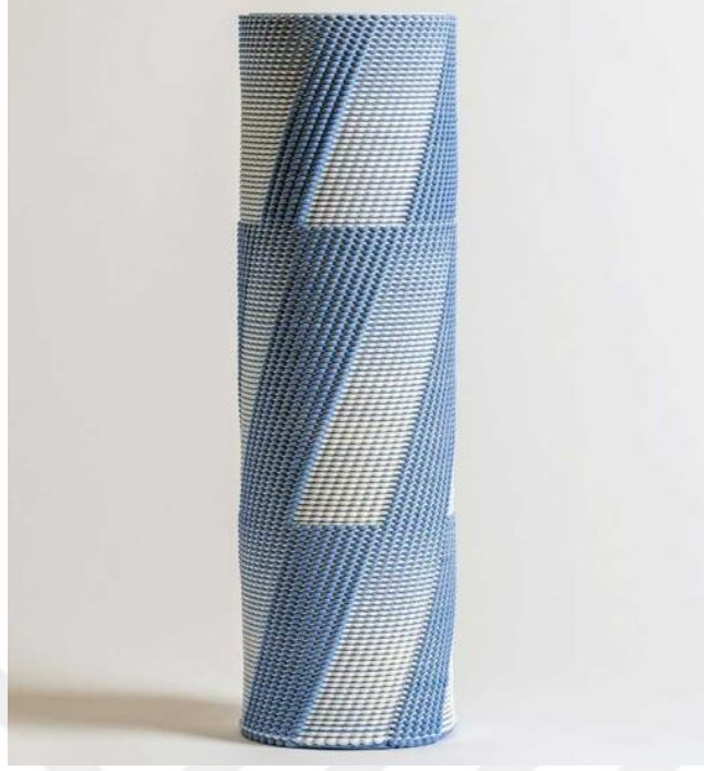
Resim 2.29. Renkli Seramik Çamur Üç Boyutlu Yazıcı Baskı Örneği
