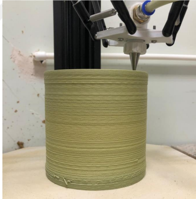
Resim 3.21. Üç Boyutlu Yazıcıyla Üretim Aşaması, FDM Yöntemi
