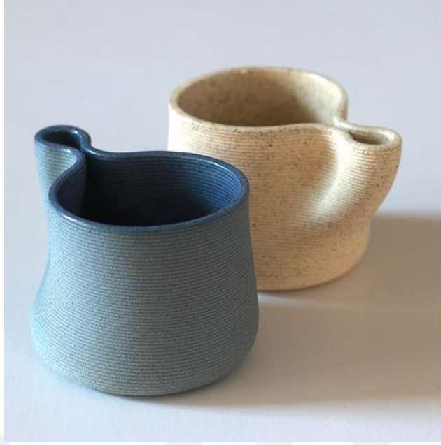
Resim 2.14. Butik Atölyede Üç Boyutlu Yazıcı ile Üretilmiş Kupa
