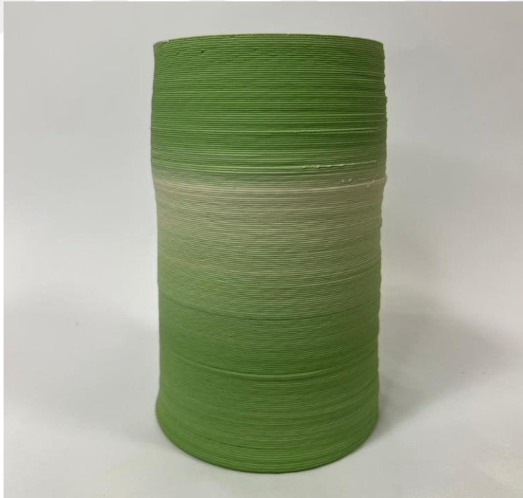
Resim 3.30. Toprağın Yeşili, Üç Boyutlu Yazıcı İle Şekillendirme, Yeşil Pigment Katkılı Porselen Çamuru, 3 mm Nozzle Uç, 1200°C
