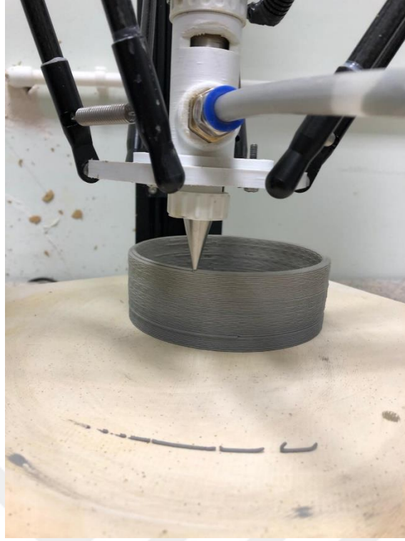
Resim 3.39. Üç Boyutlu Yazıcıyla Üretim Aşaması, FDM Yöntemi
