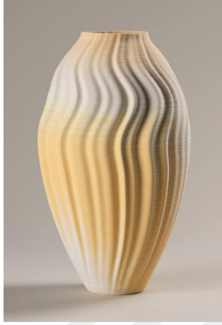
Resim 2.25. Renkli Seramik Çamurunun Üç Boyutlu Yazıcı Baskı Örneği
