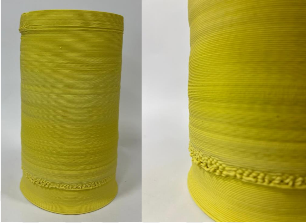
Resim 3.19. Rüya, Üç Boyutlu Yazıcı İle Şekillendirme, Sarı Pigment Katkılı Porselen Çamuru, 3 mm Nozzle Uç, 1200°C
