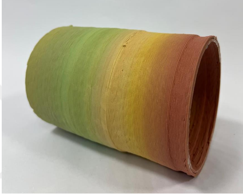
Resim 3.63. Sonbahar Kodları, Üç Boyutlu Yazıcı İle Şekillendirme, Sarı, Kırmızı ve Yeşil Pigment Katkılı Porselen Çamuru, 3 mm Nozzle Uç, 1200°C
