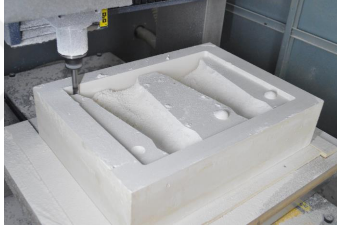
Resim 2.2. CNC İle Alçı Kalıp Üretim Süreci
