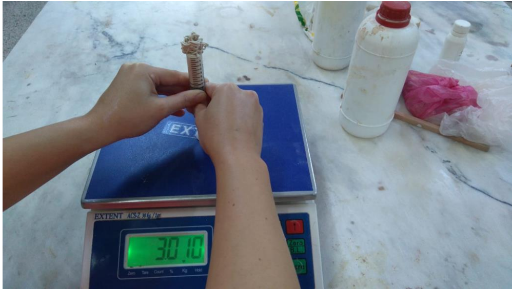
Şekil 131. Plastik hale getirilmiş çamurların bir şırınga içine doldurulup basınç deneyi uygulanması.
