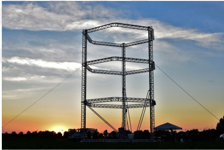
Şekil 93. İtalyan tasarım ekibi WASP'ın geliştirdiği 12 metrelik üç boyutlu yazıcı.
