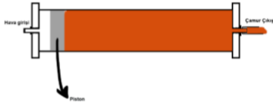
Şekil 128. Hava basıncıyla çalışan çamur deposu.
