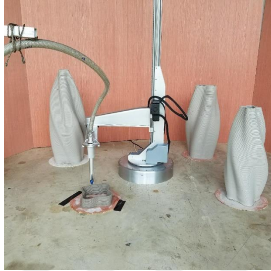
Şekil 73. Emerging Objects (Gelişen Objeler) ve 3D Potter firmasının ortak çalışmaların sonucu geliştirilmiş olan, harç yığma teknolojisiyle çalışan Potterbot XLS-1 isimli yazıcı.
