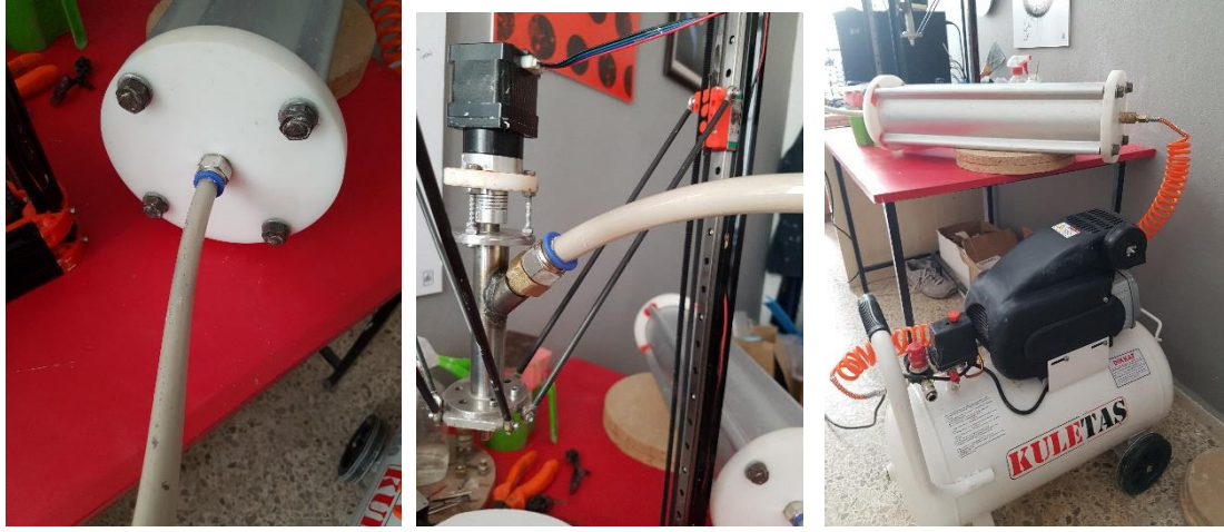
Şekil 154-155-156. Çamur deposu ile yazıcının birbirine bağlanış aşamaları.
