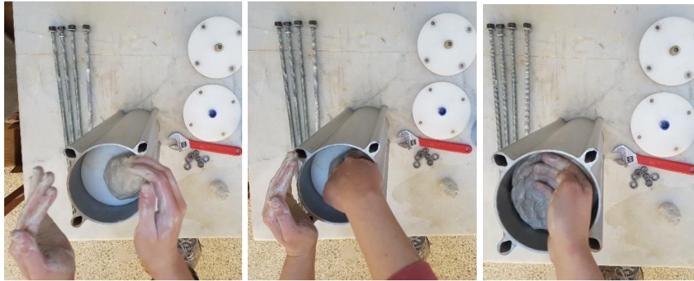
Şekil 140-141-142. Top haline getirilmiş çamurların depoya yerleştirilmesi.
