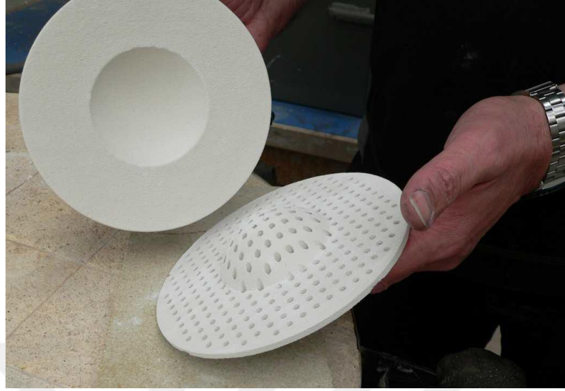
Şekil 13. Yapıştırıcıyla toz bağlama teknolojisiyle üretilmiş, seramik kâse ve destek materyali
