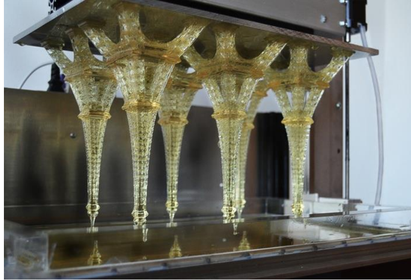
Şekil 3. Baskı işlemi tamamlandıktan sonra çekilmiş bir SLA yazıcının baskı zemini
