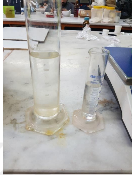
Şekil 129-130. Kullanılacak olan çamurun kuru ölçümünün yapılması ve üzerine eklenecek su miktarının ölçülmesi.
