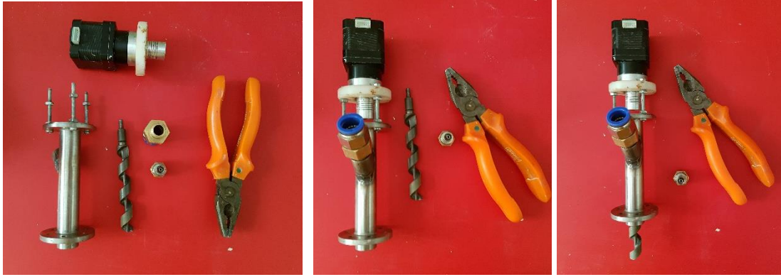
Şekil 146-147-148. Ekstrüderin parçaları ve montaj aşaması.
