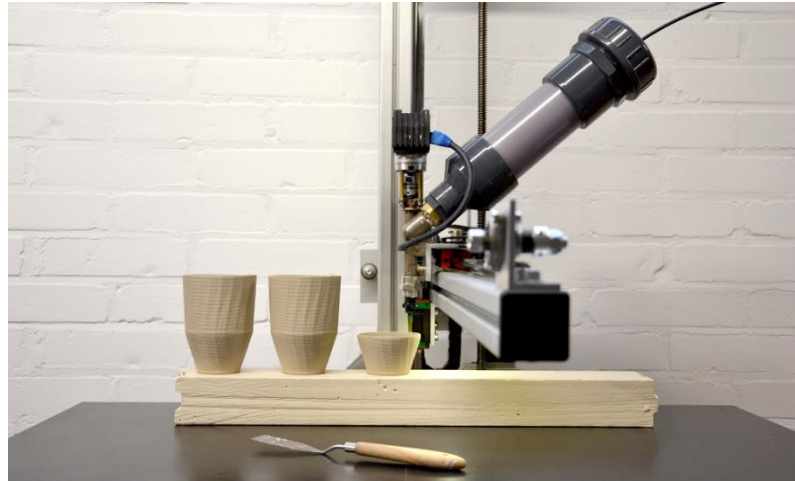
Şekil 45. Vormvrij 3D firmasının geliştirdiği, harç yığma teknolojisiyle çalışan Lutum yazıcı.
