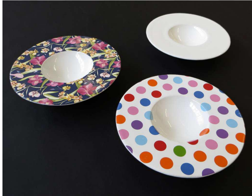
Şekil 14. Yapıştırıcıyla toz bağlama teknolojisiyle üretildikten sonra sırlanıp dekorlanmış seramik kâseler
