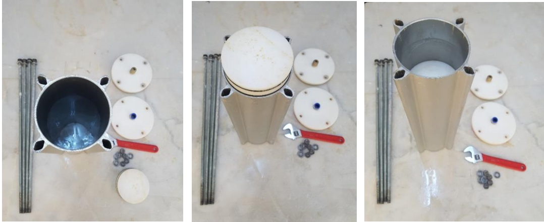
Şekil 134-135-136. Çamur deposunun parçaları ve pistonun depoya yerleştirilmesi.
