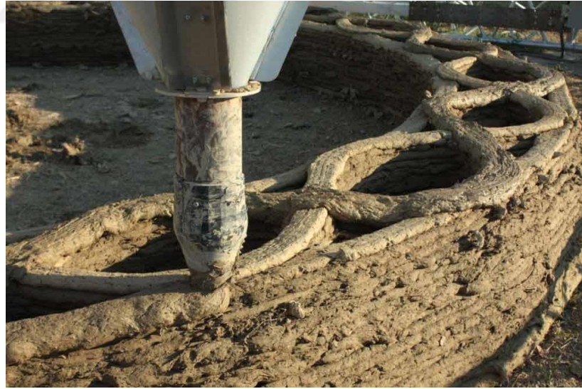
Şekil 95. İtalyan tasarım ekibi WASP'ın geliştirdiği 12 metrelik üç boyutlu yazıcının ekstrüder kısmı.
