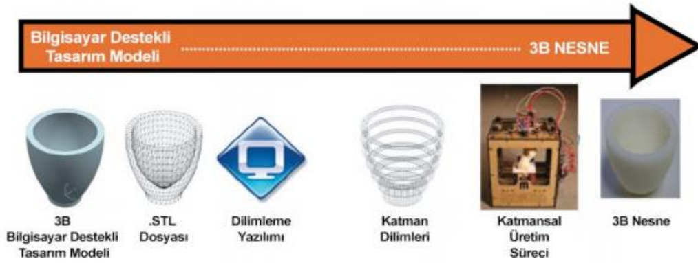
Resim 1. 3B Yazıcı Ürün Oluşturma Süreci
