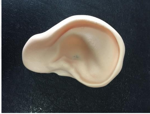
Resim 5.15 3 boyutlu yazıcıdan çıkartılmış sert yapıda kulak numunesi.
