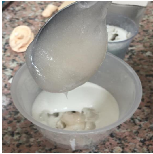
Resim 5.21 RTV830 kiti ile hazırlanmış karışım döküm işlemleri.
