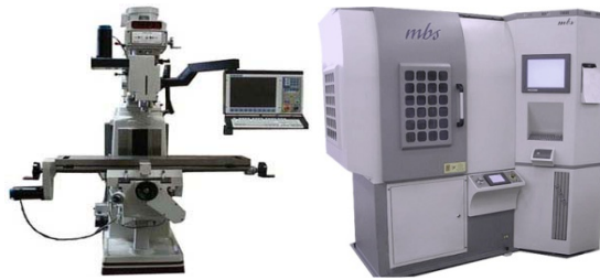
Resim 2.2 Nümerik Kontrollü Takım Tezgâhları a. CNC b. NC
