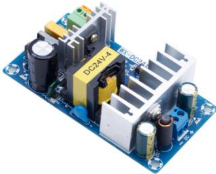
Şekil 4.63 Switch Mode Güç Kaynağı[29]
