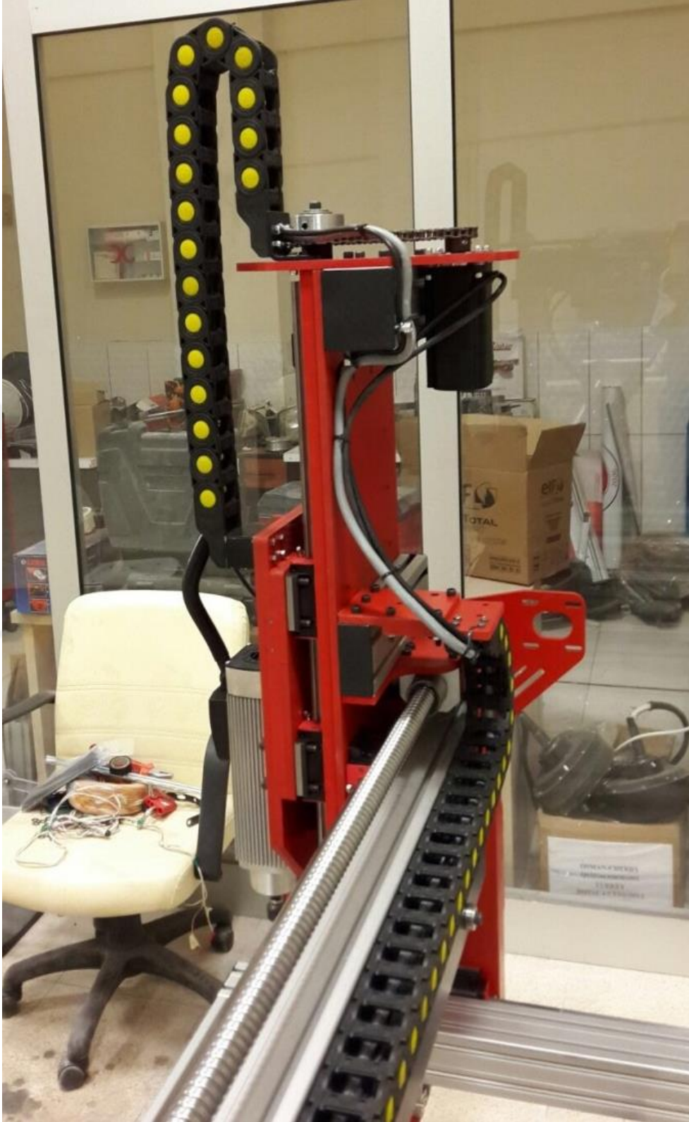
Şekil 4.38 Z Ekseni Motor Bağlantı Plakası Montajı
