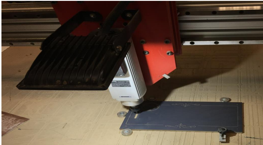
Şekil 6.4 Kapı İsimliklerinin CNC Tezgâhta İşlenmesi
