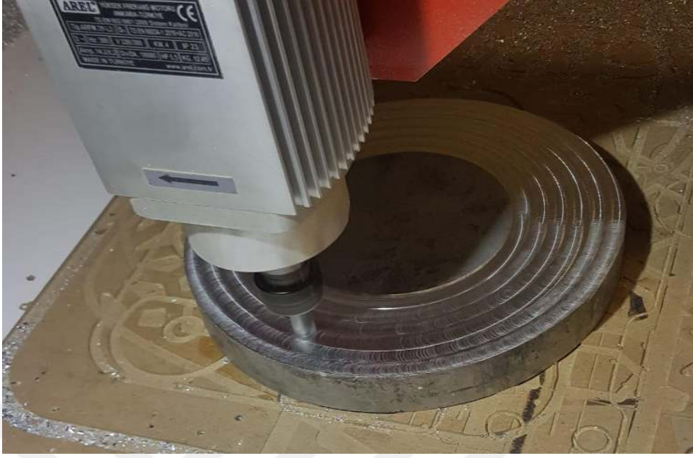
Şekil 6.7 Hub Motor Parçalarının CNC Tezgâhta İşlenmesi
