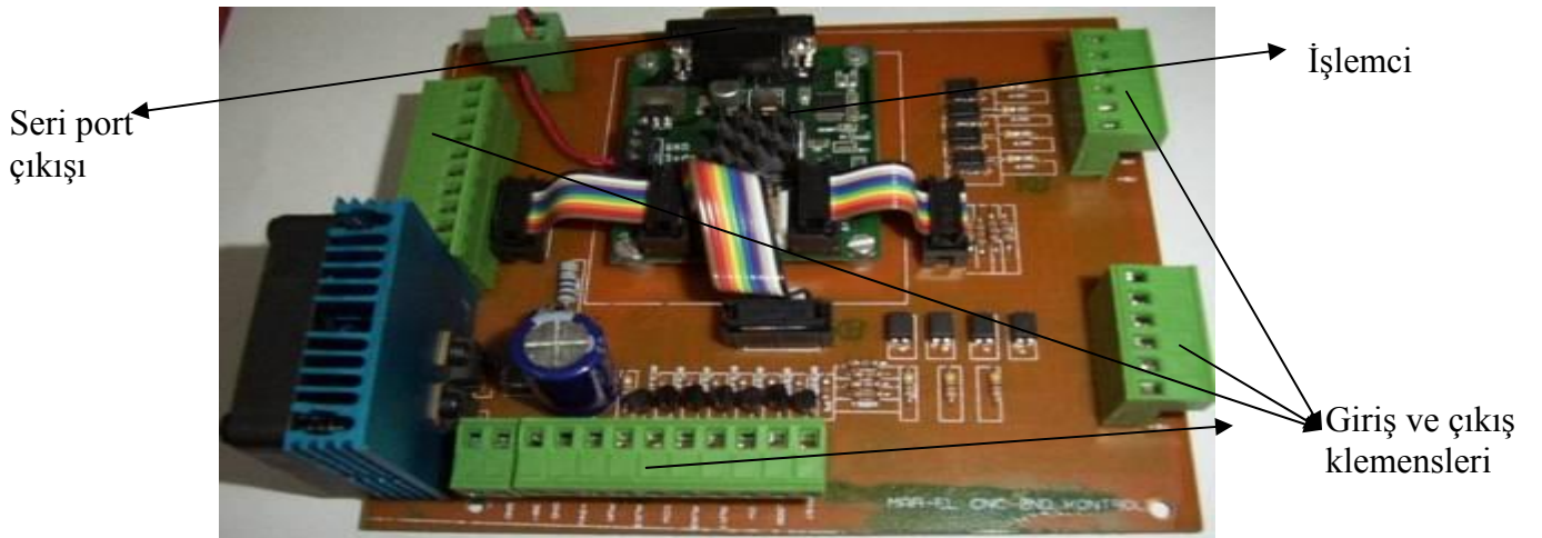
Şekil 4.9 Desk CNC Kontroller
