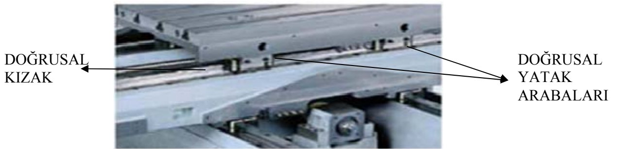
Şekil 3.7 Endüstriyel CNC Tezgahlarda Kullanılan Doğrusal Yataklar
