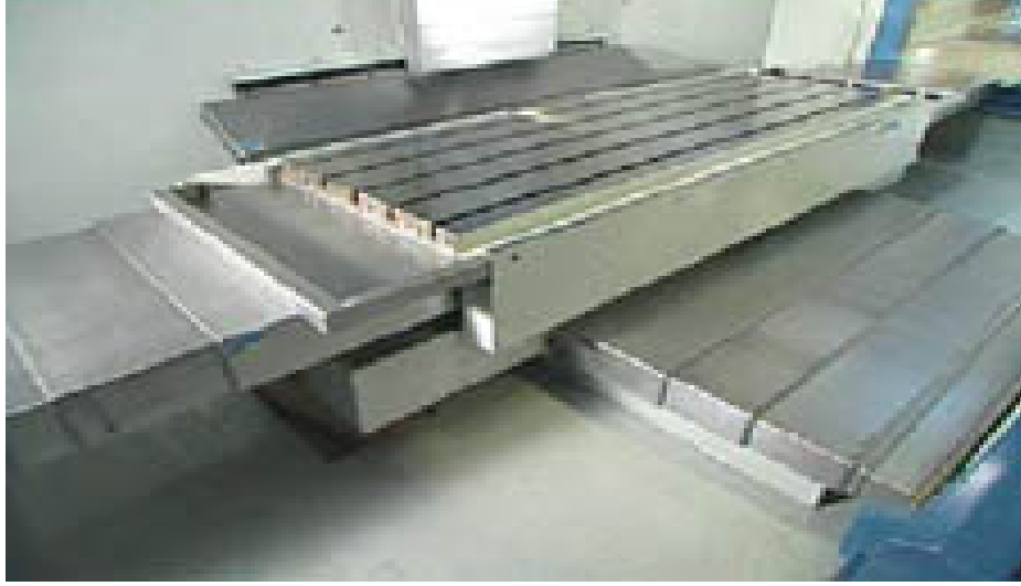
Şekil 3.10 CNC Tezgâhın Gövdesi
