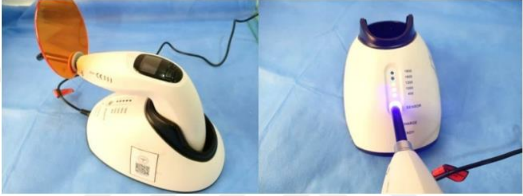
Şekil 3.7. Çalışmada kullanılan LED ışık kaynağı ve ışık yoğunluğunun kontrol edilmesi
