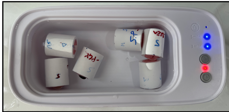
Şekil-3.13: Macun artıklarından arındırılması için ultrasonik cihazda 5 dk bekletilmesi
