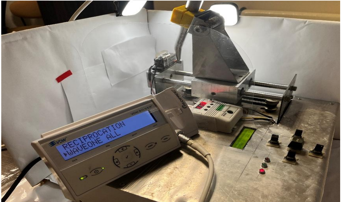
Şekil 3. 15. Kırık parçaların toplanabilmesi için test cihazının şeffaf plaka ile sınırlandırılması
