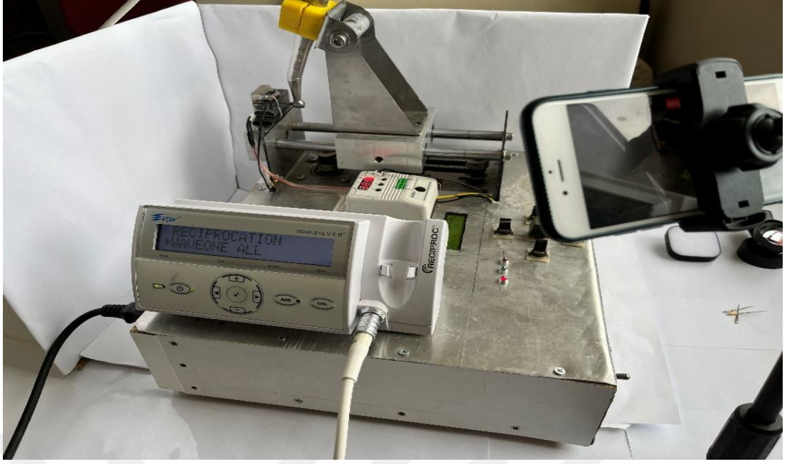
Şekil 3. 14. VDW Silver Endodontik Motor ve dinamik döngüsel yorgunluk test cihazı
