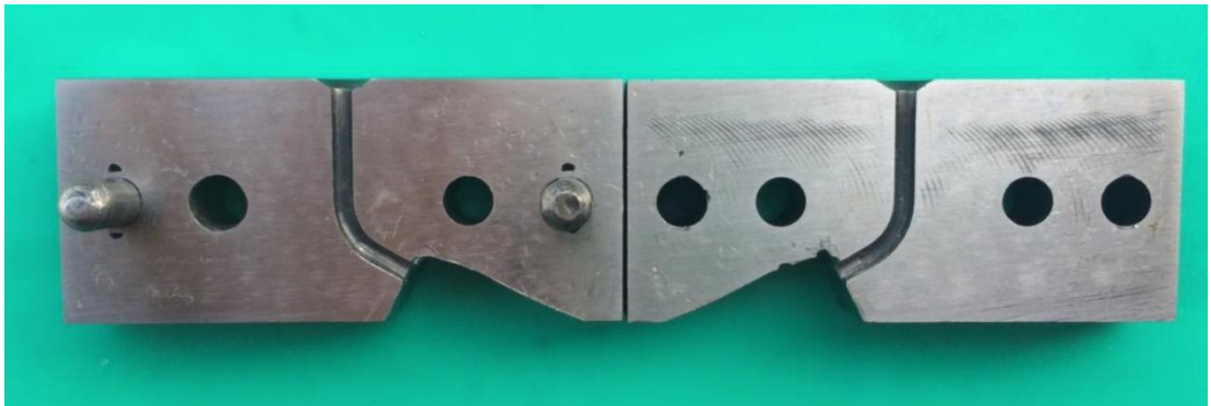
Şekil 3. 12. 60° eğimli paslanmaz çelik yapay kanal
