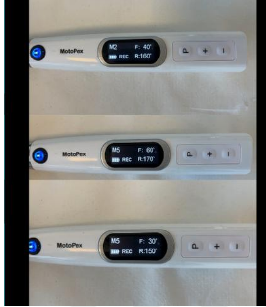
Şekil 3. 10. Motopex endomotor üzerinde ayarlanmış açı değerleri
