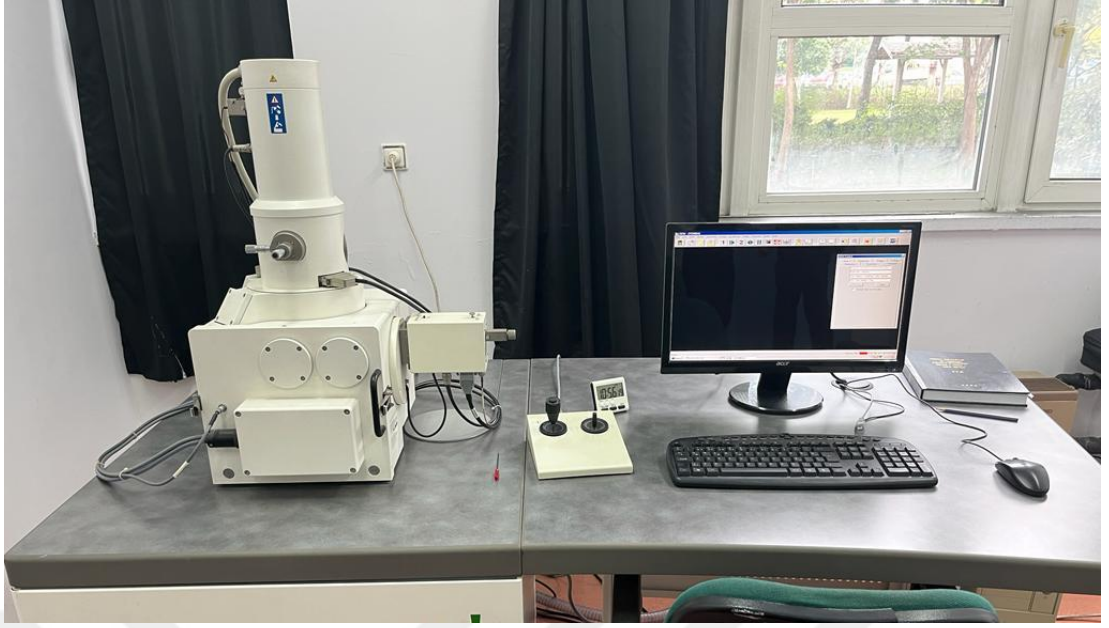
Şekil 3. 14. Çalışmada kullanılan SEM (Zeiss, LEO-1430) cihazı
