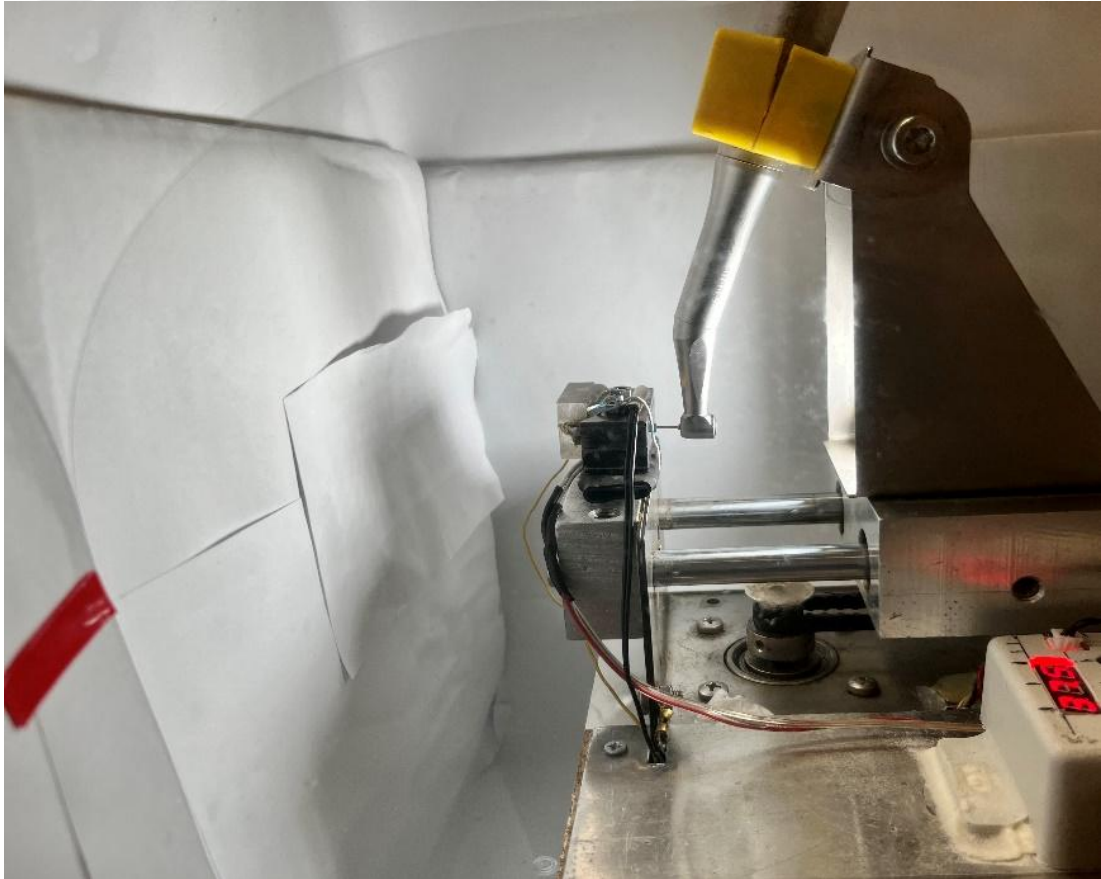
Şekil 3. 13. Çalışmada kullanılan döngüsel yorgunluk test cihazı ve sıcaklığın ayarlanması
