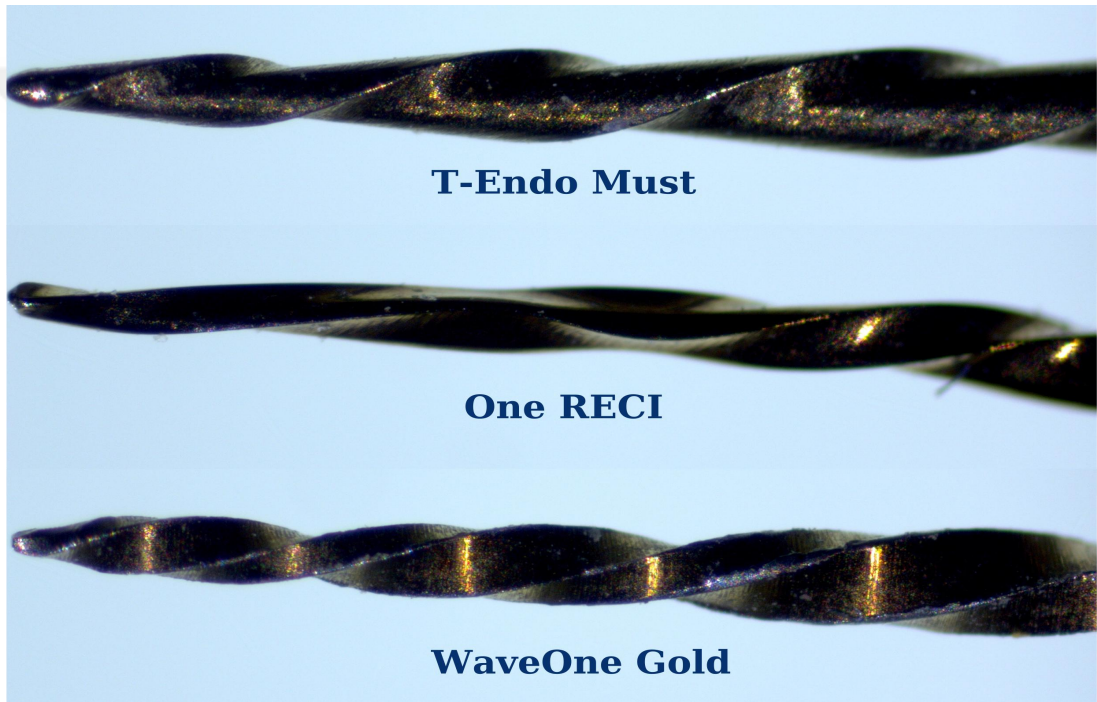
Şekil 4. 1. Her eğe grubundan deformasyon gösteren örneklerin mikroskop ile çekilmiş görüntüleri
