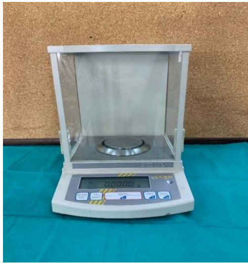
Resim 3. Örneklerin tartıldığı hassas terazi
