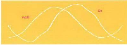
Şekil 6.12 Üçgen-yıldız bağlantıda, gerilim ve akım dalga şekilleri
