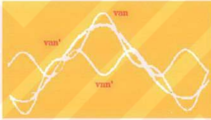
Şekil 6.5 Nötrü izoleli yıldız-yıldız bağlantıda gerilim ve akım dalga şekilleri
