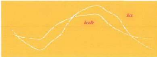
Şekil 6.14 Üçgen-üçgen bağlantıda, faz ve hat akımları
