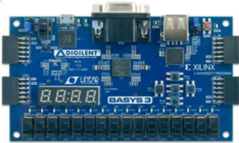
Şekil 3.19. FPGA Deneme Kartı Basys3
