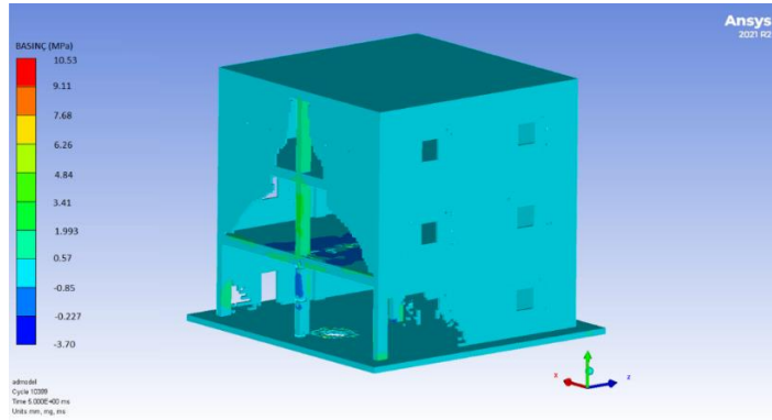
Şekil 4.107. PZ-52AO Basınç gerilmesi diyagramları
