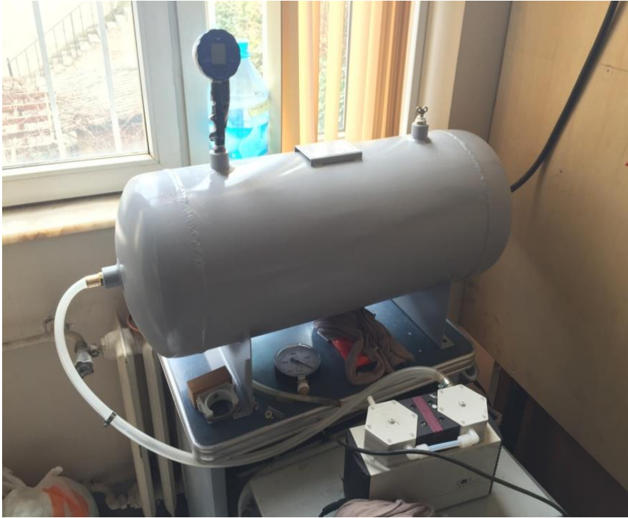
Şekil 3.5 : Basınç tankı ve vakum pompası.
