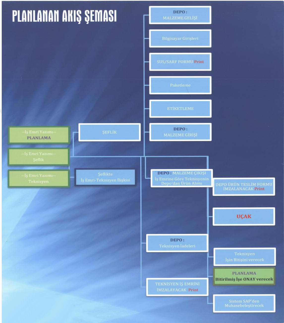
Şekil 5 : Uçak Bakım ve Onarım Şirketi RFID Tabanlı Akış Şeması
