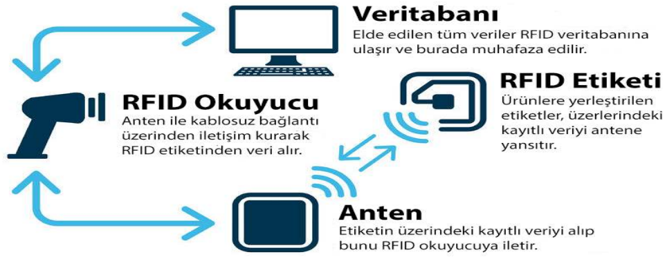
Şekil 1 : RFID Sistemi Çalışma Prensibi
