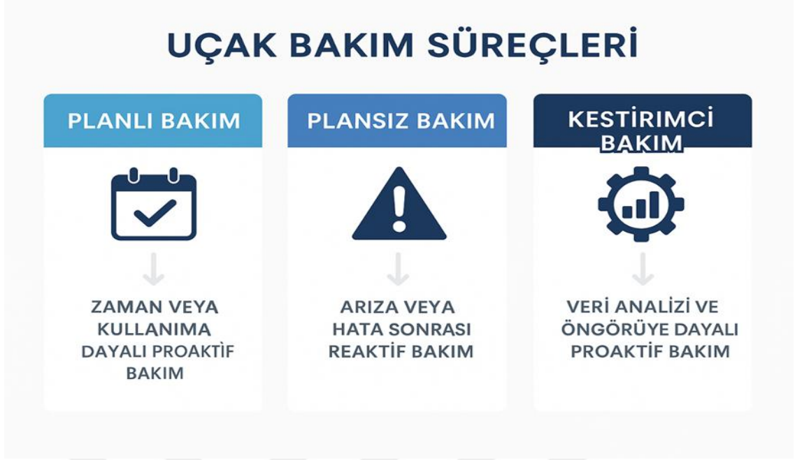
Şekil 2.1. Uçak bakım süreçleri (Kinnison ve Siddiqui (2013); Jardine ve diğerleri (2006); FAA (2021))
