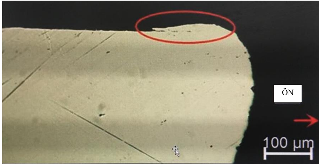
Görsel 4.40. Dovetail yuvasında meydana gelen çapaklanma
