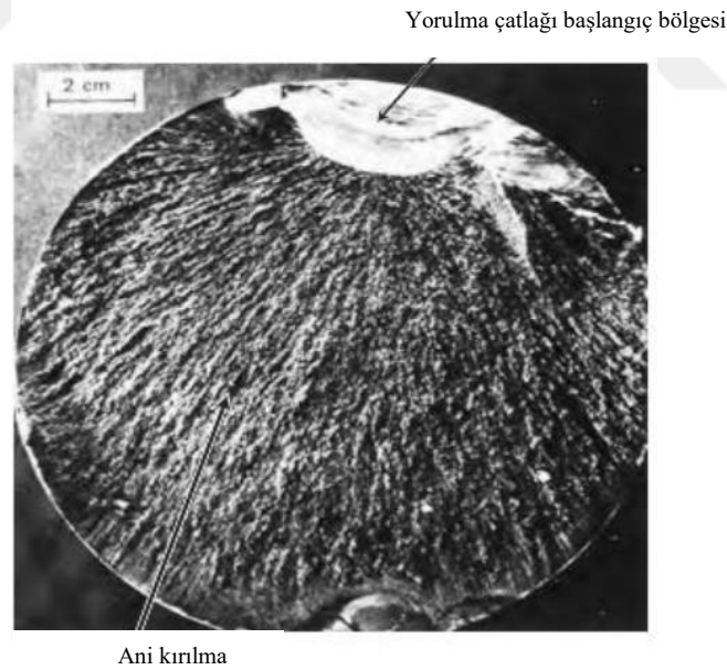
Görsel 3.14. Yorulma kırılması sonucu malzeme kesiti (Callister, 2007)
