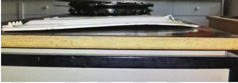
Görsel 4.15. A/I/T dış kapağındaki deformasyon
