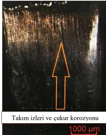
Görsel 4.45. Takım izleri ve çukur korozyonu
