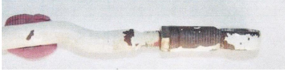
Görsel 4.19. Rod asamblesindeki deformasyon
