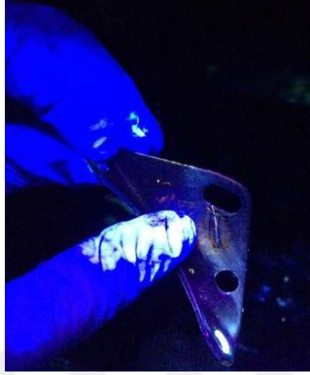
Görsel 3.24. Bir test parçasının siyah ışık altında incelenmesi
