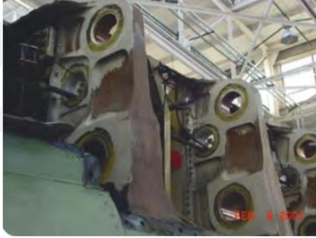
Görsel 3.12. F-18 uçağında korozyon (Rose and Legg, 2014)
