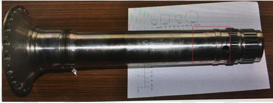
Görsel 4.42. Hasarlı kompresör şaftı
