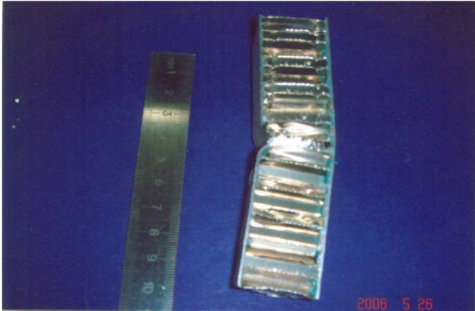
Şekil 7.3 Panel burkulması sonucu meydana gelen kompozit yapı
