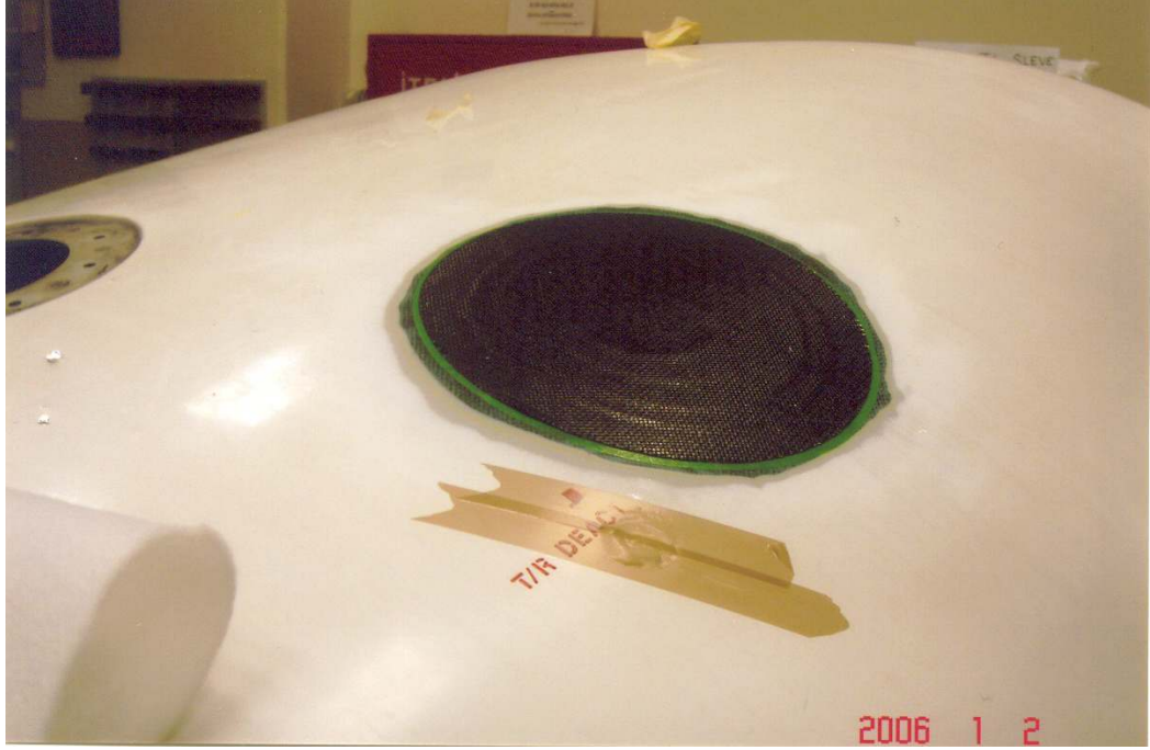
Şekil 7.92 Oryantasyon gereklerine azami ölçüde riayet edilerek tatbik edilen son karbon katından sonra parça temizlenmiş ve kontrol edilmiştir
