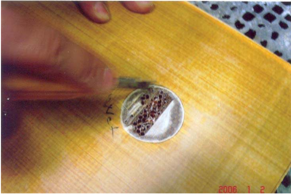
Şekil 7.58 Petek hücrelerinde zarar gördüğü gözlenmiştir
