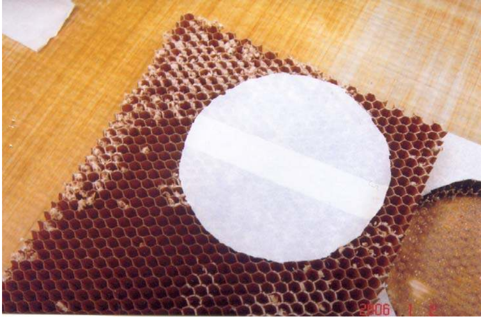
Şekil 7.62 Tamir edilecek bölgenin boyutlarına uygun hücre şablon yardımıyla kesilerek hazır hale getirilmiştir
