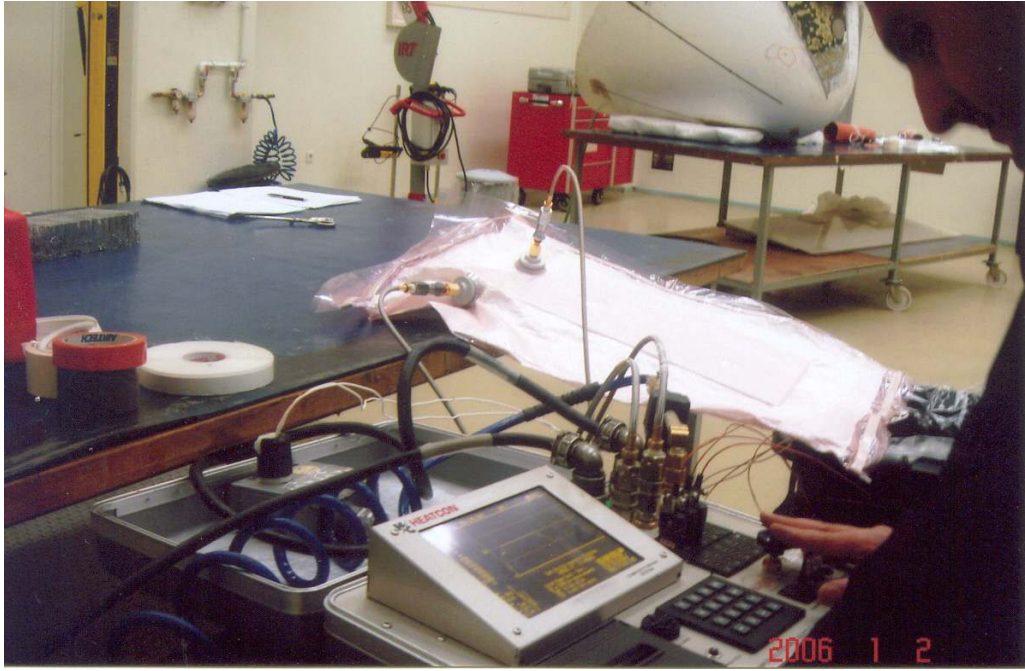
Şekil 7.82 Tamir vakum torbasına alındı. 250°F (123°C) derecede 120 dakikalık kürleme işlemine tâbi tutuldu
