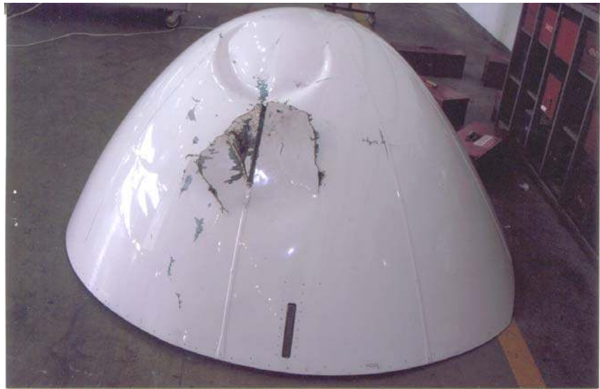
Şekil 7.104 A 320 uçağının hasara uğramış radomu
