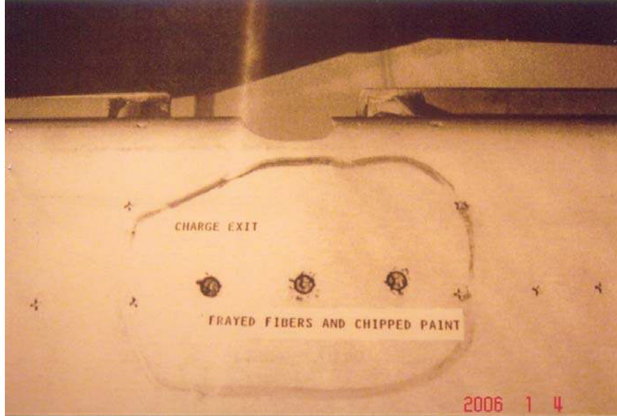
Şekil 5.2 Bozulmuş fiberler ve boya bozuklukları (Boeing 4 , 1996)
