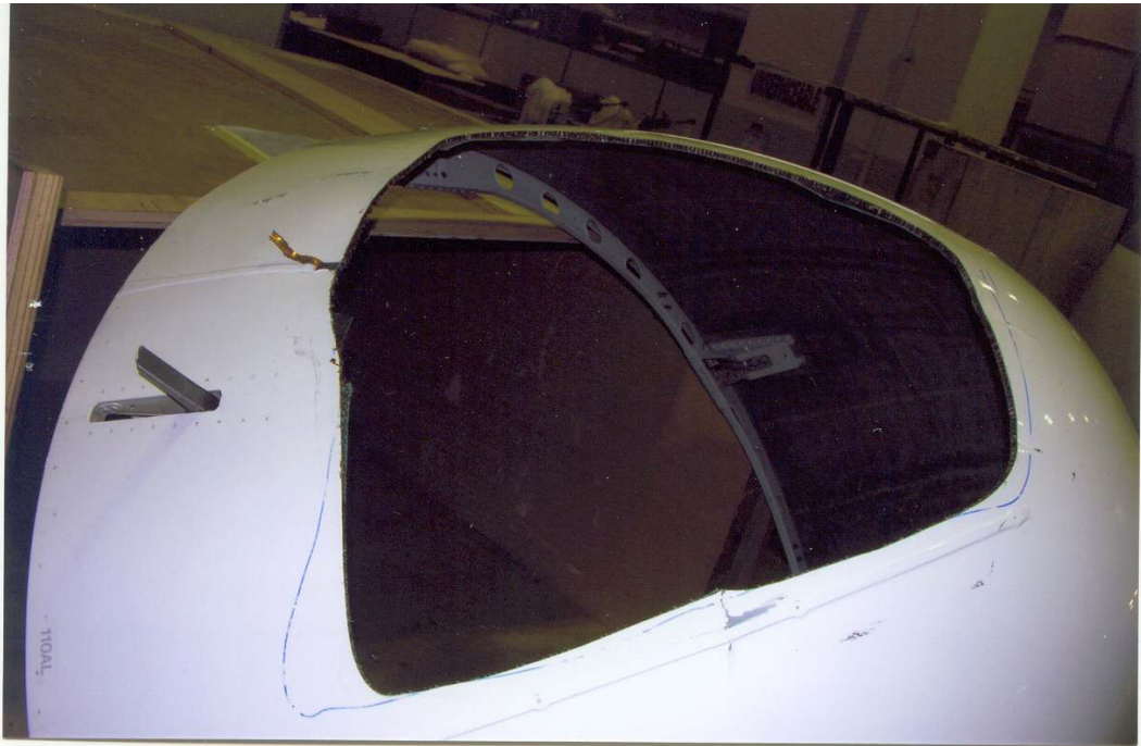
Şekil 7.107 Airbus 320 uçağının kuş çarpması sonucu hasarlanan radomundan tamir edilmesi gereken parçanın çıkartılmış halinin görünümü
