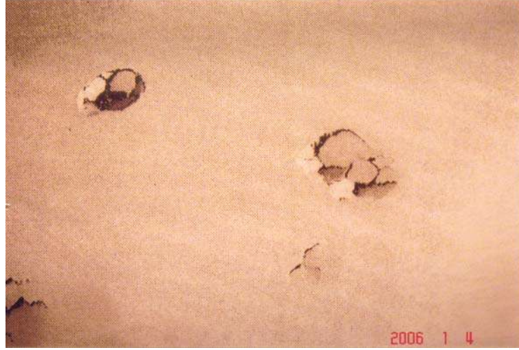
Şekil 5.6 Çarpma hasarı sonucu yırtılmış yüzey tabaka ve petek hücrelerin ortaya çıkmış hali gözle tespit edilebilir (Boeing 4 , 1996)
