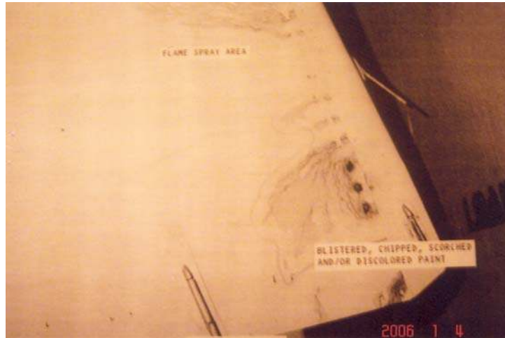
Şekil 5.5 Yıldırım düşmesi sonucu rengi değişmiş, kaybolmuş, bozulmuş boya hatalarının gözle muayenesi mümkündür (Boeing 4 , 1996)
