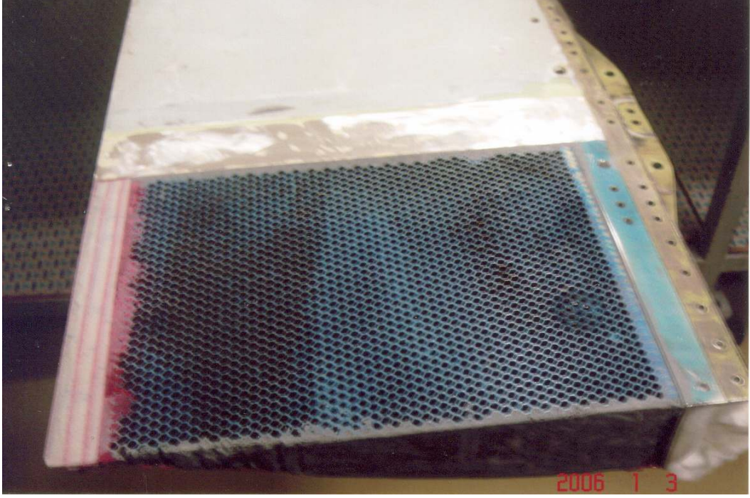
Şekil 7.101 Parça kür işleminden sonra petek hücrelerin üzeri temizlenmiş, zımparalanmış, yüzey düzgünlüğü sağlanmıştır
