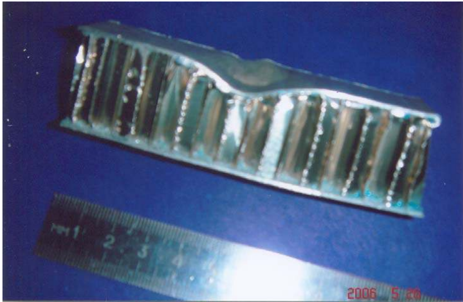
Şekil 7.7 Bölgesel basınç sonucu oluşan hasar
