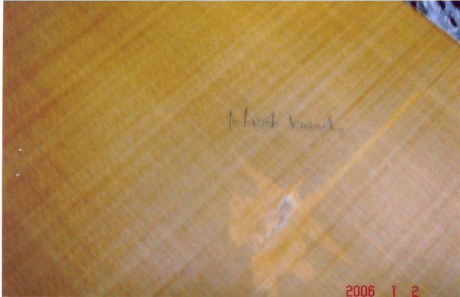
Şekil 7.36 Hasarlanmış kompozit sandviç yapının gözle muayenesi
