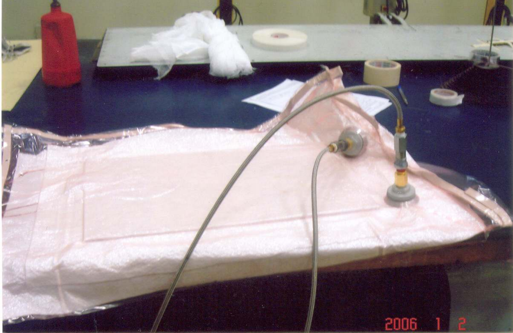
Şekil 7.84 Tamir tekrar vakum torbasına alındı. 250°F (123°C) tekrar 120 dakikalık kür işlemine tabi tutuldu
