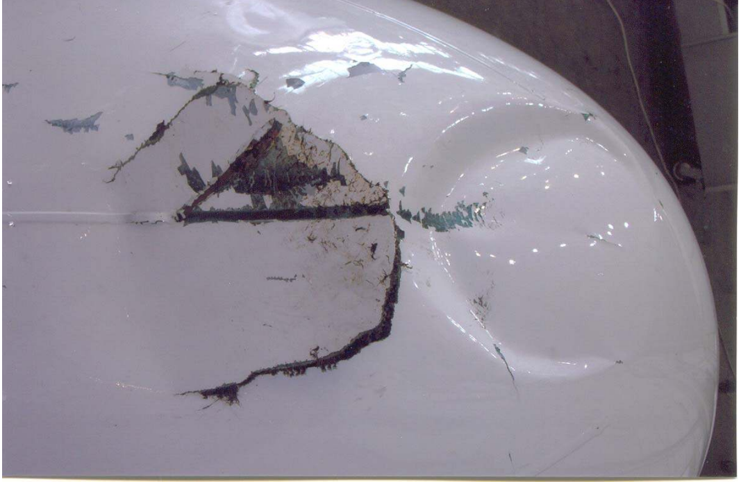
Şekil 7.105 Airbus 320 radomunun ağır hasarlanmış radomunun dıştan görünümü
