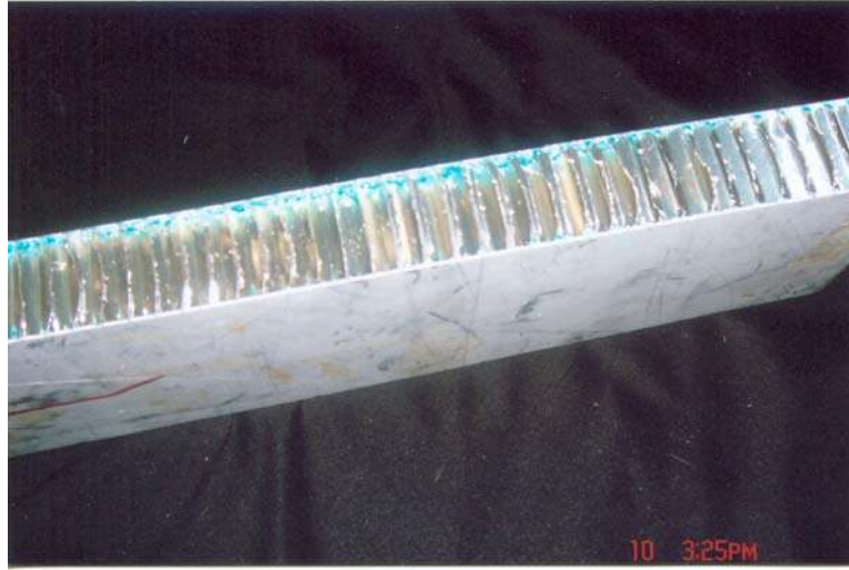
Şekil 3.17 Isıtılmış basınç altında üretilmiş metal tabaka, metal petek hücre (alüminyum) den oluşan balpeteği kompozit malzeme
