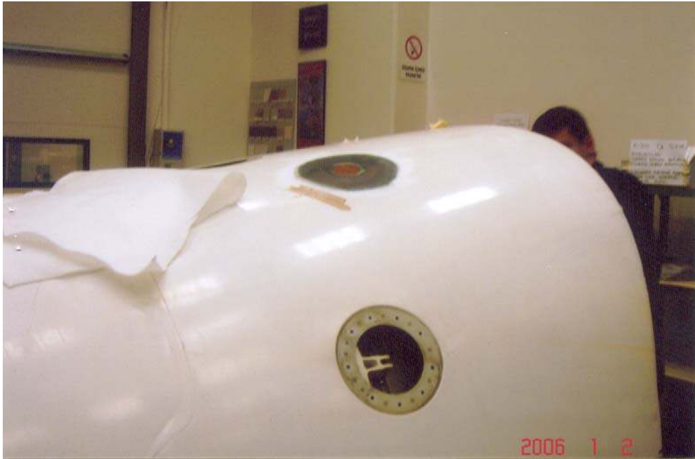
Şekil 7.89 Vakumdan sonra petek hücrelerin yerleştiği yer zımparalanarak temizlenmiş, yüzey düzgünlüğü limitler ölçüsünde sağlanmıştır
