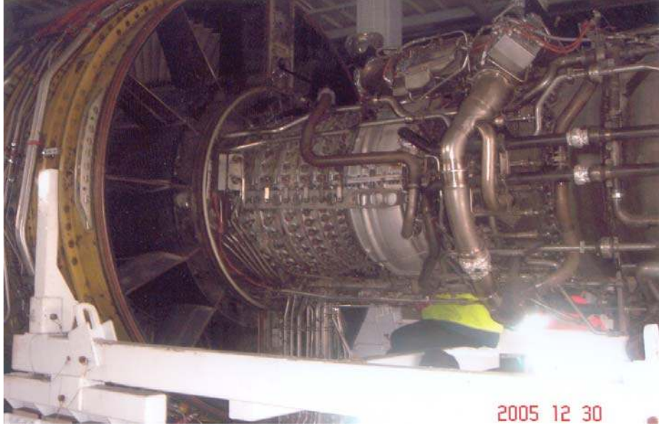
Şekil 7.39 Airbus 300 uçağının CF6-50 General Electric turbofan motoru
