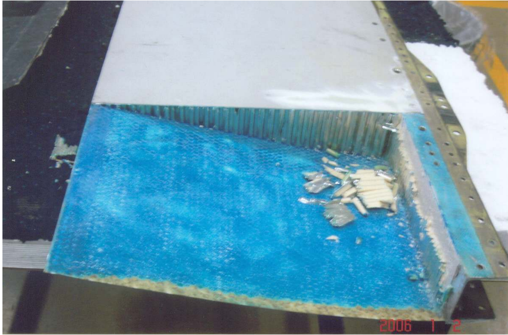
Şekil 7.98 Hatalı bölge yapıdan (yüzey, petek hücreler) çıkartılmıştır
