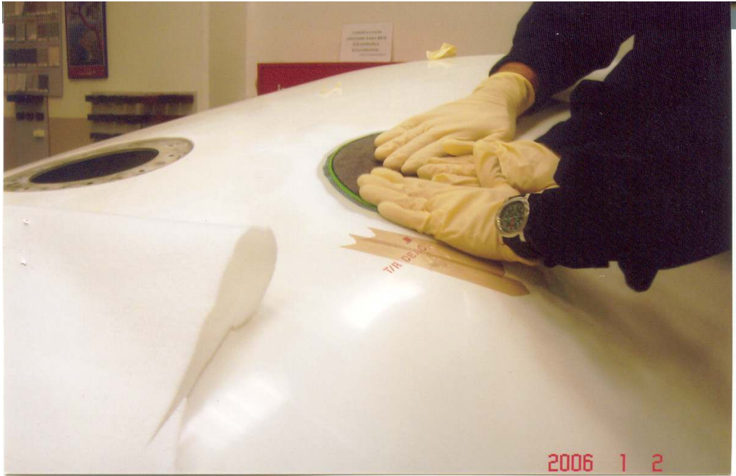
Şekil 7.91 Karbon tabakaları, yapışkan film tabakalarıyla beraber uygulanmıştır
