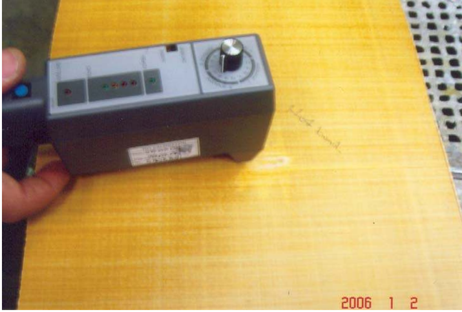
Şekil 7.37 Tap cihazının hasarlı bölgeye uygulanması
