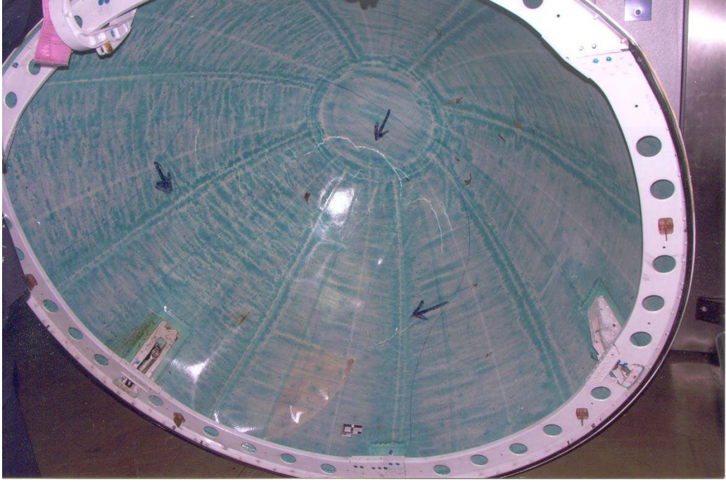
Şekil 7.106 Airbus 320 radomunun iç bölgedeki hasarının görünümü
