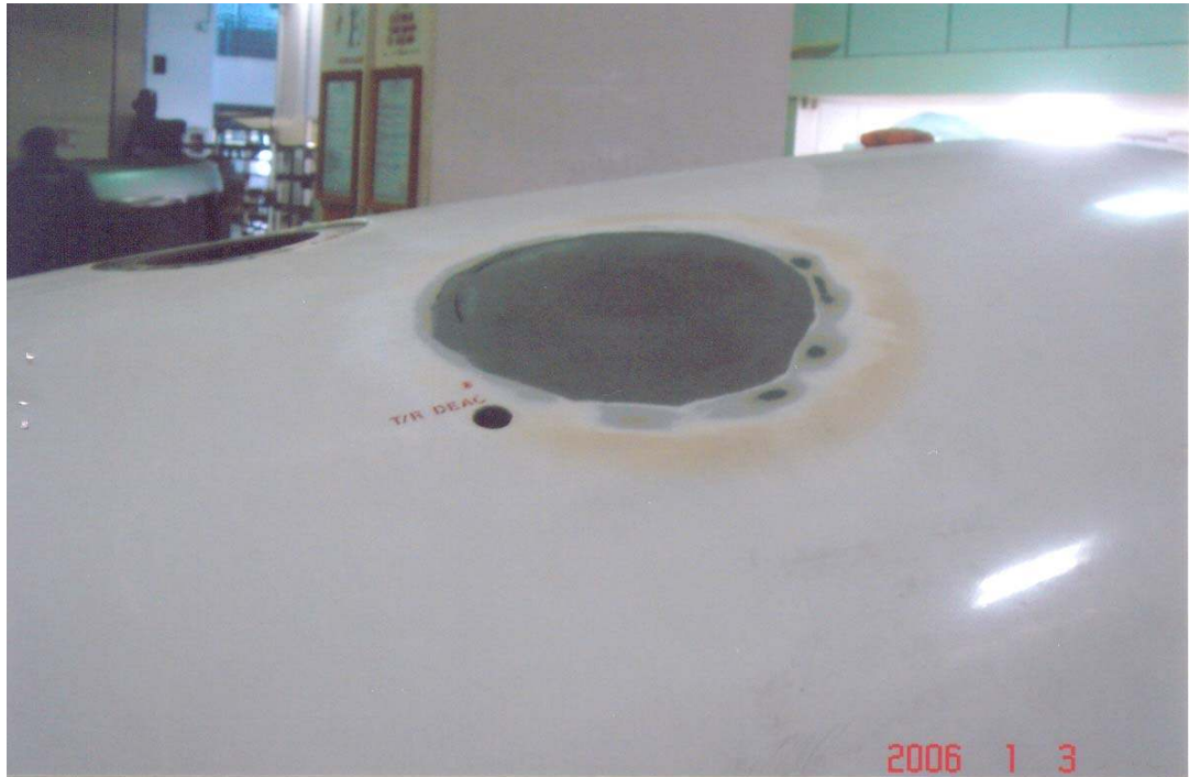
Şekil 7.95 Bu işlemlerden sonra tamir edilen bölümün tahribatsız muayeneleri yapılarak zımparalanmış, boyanmış ve parça servise verilmiştir
