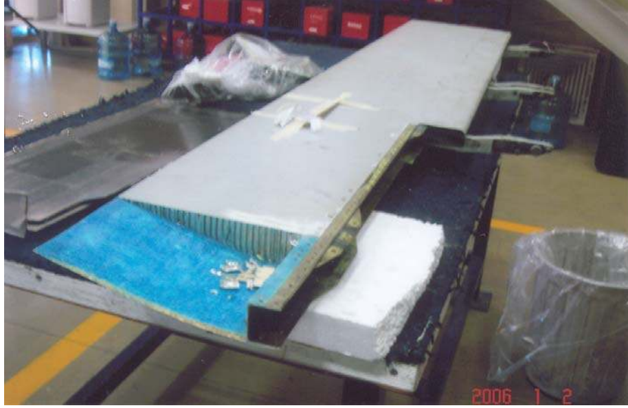
Şekil 7.47 Ayrılmaya (disbonding) uğramış prepreg alüminyum petekli sandviç yapının çıkartılması
