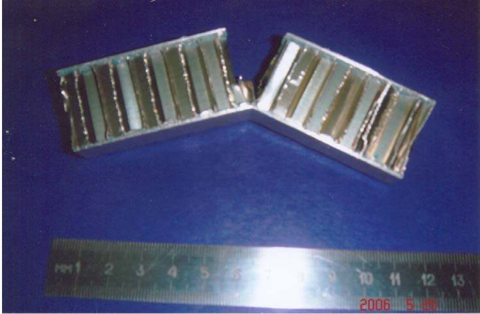
Şekil 7.1 Dayanç hatası sonucu meydana gelmiş kopma görüntüsü
