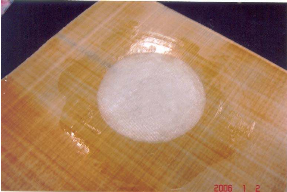
Şekil 7.70 Tamir katları oryantasyonlara dikkat edilerek yayıldı. Tabaka uyumu sağlandı
