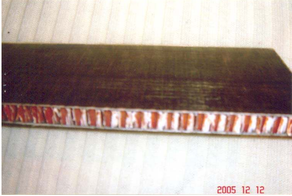
Şekil 4.11 18 katlı karbon takviyeli tabakanın prepreg usulüyle birleştirilmesiyle ortaya çıkan yüksek performanslı yüzey tabakaları ve kevlar petek yapı
