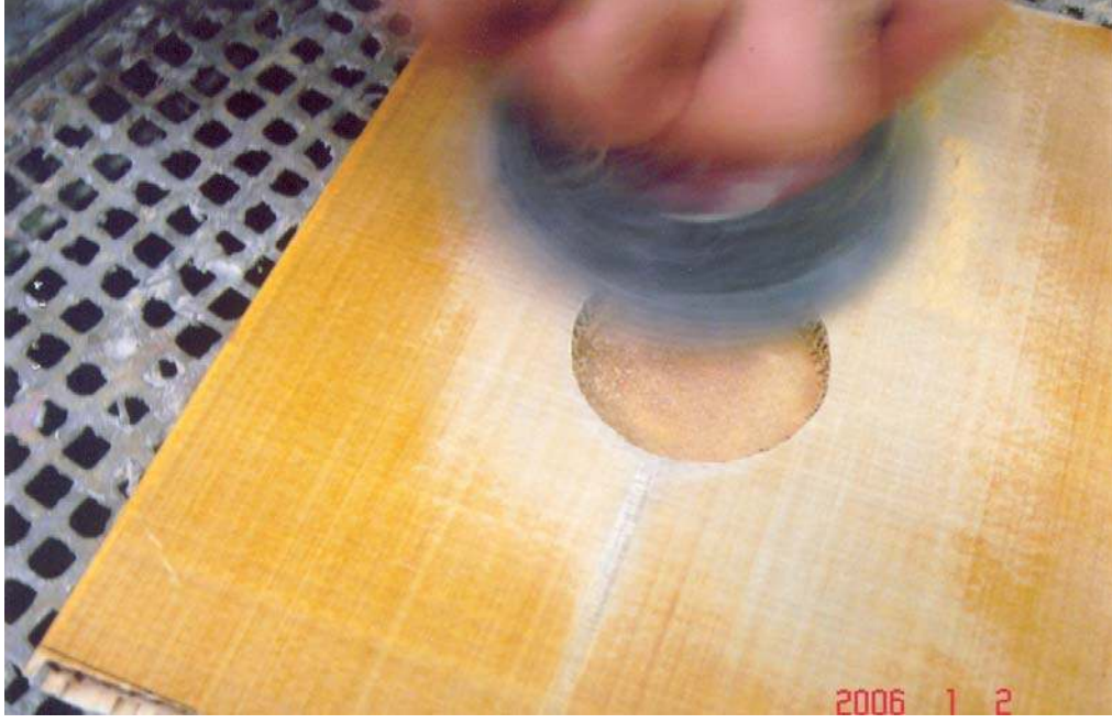
Şekil 7.75 Bölge tamamen zımpara makinasıyla temizlenerek, gerekli olan yüzey düzgünlüğü sağlandı. Etraftaki boya ve parlaticılar çıkarıldı
