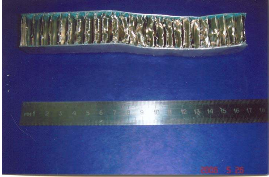
Şekil 7.4 Kesme kıvrımı hatası sonucu oluşan hatalı yapı
