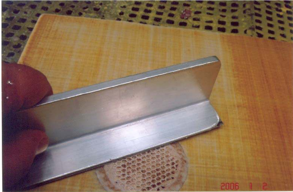
Şekil 7.68 Tamir edilen bölge vakum torbasından çıkarılarak temizlendi ve yüzey düzgünlüğü sağlandı
