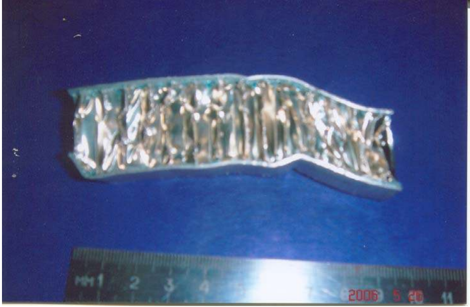
Şekil 7.2 Rijitlik hatası sonucu meydana gelmiş yapı görüntüsü
