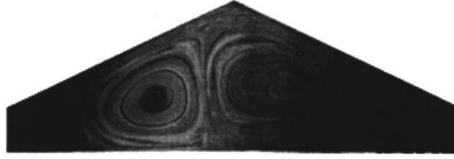
Şekil 1.10. Üçgen kapalı ortamda Gr=10^4 ve boy-en oranı 0.5 iken görüntülenmiş akım yapısı (Holtzman vd., 2000).
