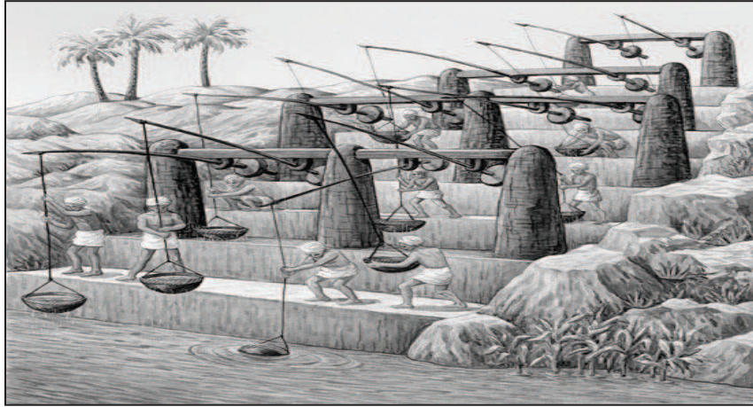
Şekil 1.1. Su nakil sistemi – Kaldıraçlar [1]
