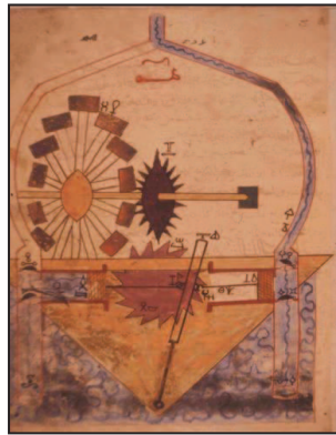
Şekil 1.3. Cezeri'nin tasarlamış olduđu pistonlu pompa [1]
