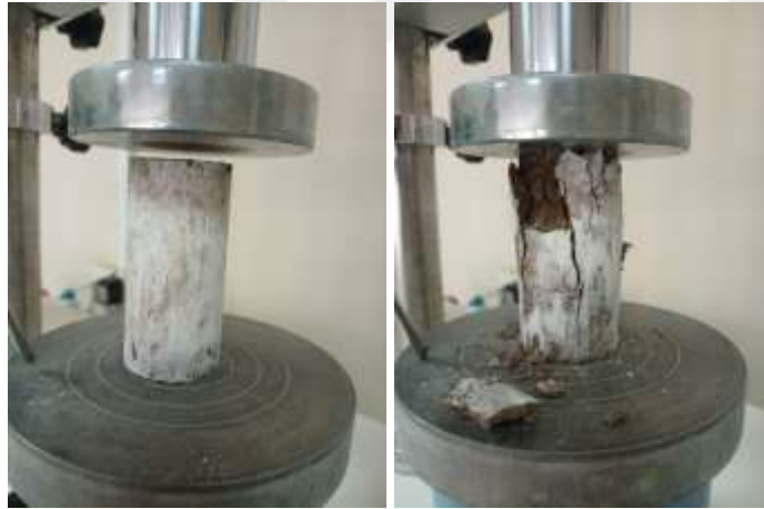
Şekil 27: 1. Optimizasyon Donma-Çözölme 3. Çevrim Serbest Basınç Dayanımı
