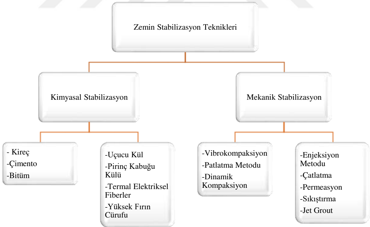
Şekil 2: Zemin Stabilizasyon Türleri
