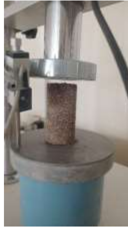
Şekil 36: 3. Optimizasyon Donma-Çözülme 6. Çevrim Serbest Basınç Dayanımı
