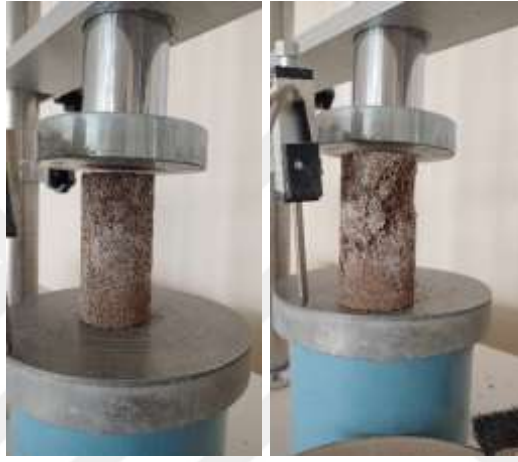
Şekil 40: 4. Optimizasyon Donma-Çözülme 6. Çevrim Serbest Basınç Dayanımı
