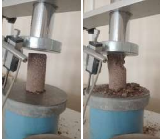
Şekil 33: 2. Optimizasyon Donma-Çözülme 9. Çevrim Serbest Basınç Dayanımı
