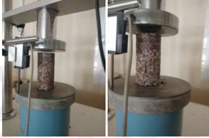
Şekil 21: 1. Optimizasyon 28 Günlük Serbest Basınç Dayanımı
