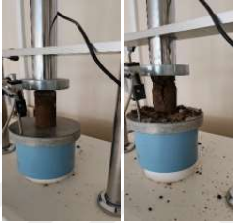
Şekil 54: 4. Optimizasyon Islatma 28 Günlük Serbest Basınç Dayanımı
