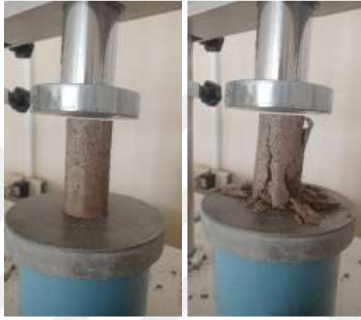
Şekil 48: 1. Optimizasyon Islatma 14 Günlük Serbest Basınç Dayanımı
