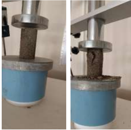
Şekil 52: 4. Optimizasyon Islatma 7 Günlük Serbest Basınç Dayanımı
