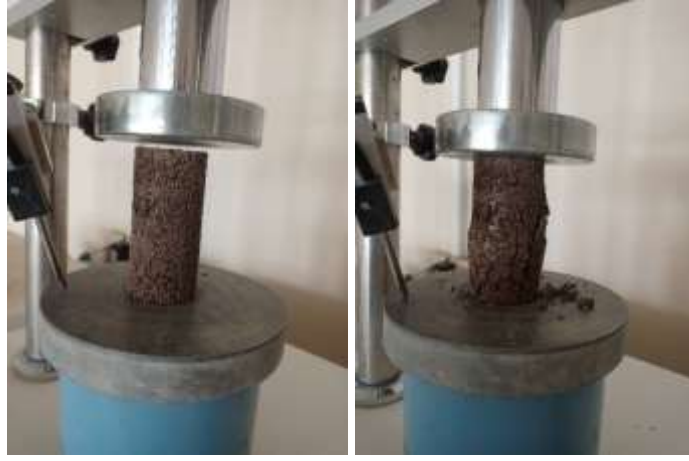
Şekil 47: 1. Optimizasyon Islatma 7 Günlük Serbest Basınç Dayanımı
