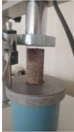
Şekil 36: 3. Optimizasyon Donma-Çözülme 6. Çevrim Serbest Basınç Dayanımı
