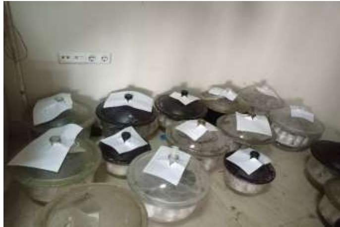
Şekil 20: Hazırlanan Zemin Numunelerinin Desikatörlerde Kürlenmesi
