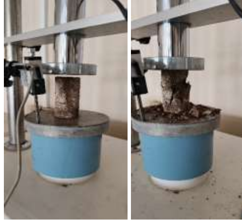
Şekil 41: 4. Optimizasyon Donma-Çözülme 9. Çevrim Serbest Basınç Dayanımı
