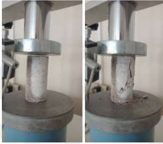
Şekil 29: 1. Optimizasyon Donma-Çözülme 9. Çevrim Serbest Basınç Dayanımı
