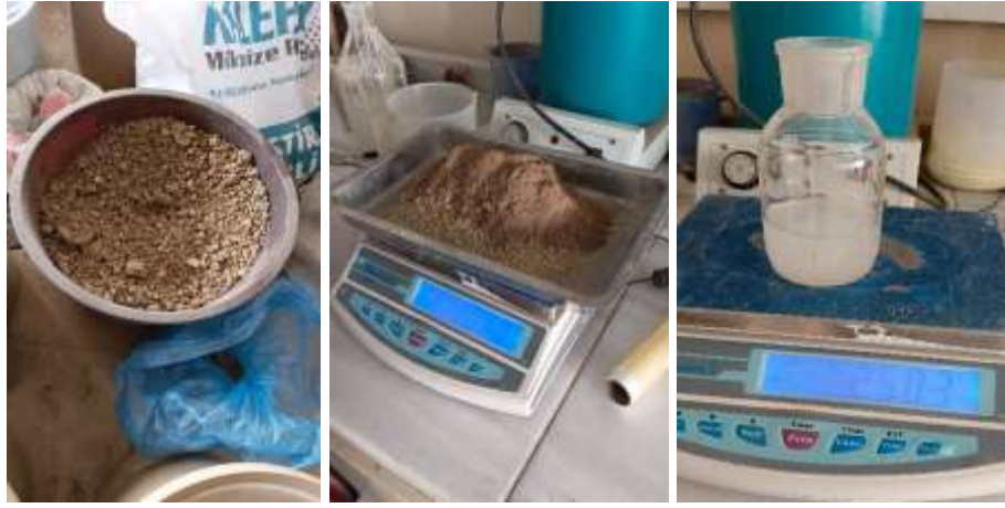
Şekil 17: Zemin Numune İçerikleri (Doğal Zemin, Uçucu Kül, Aktivatör)
