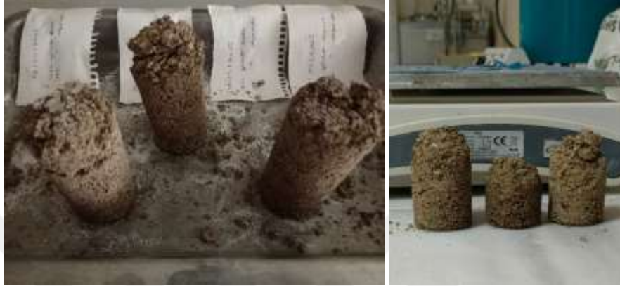
Şekil 43: 1. Optimizasyon Islanma-Kuruma Deneyi
