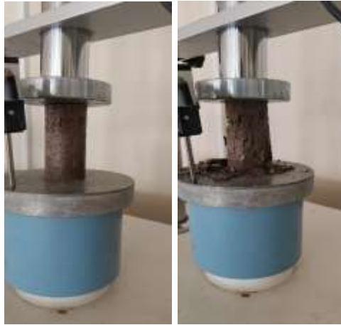
Şekil 49: 1. Optimizasyon Islatma 28 Günlük Serbest Basınç Dayanımı
