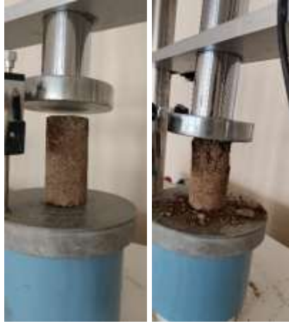
Şekil 31: 2. Optimizasyon Donma-Çözülme 3. Çevrim Serbest Basınç Dayanımı
