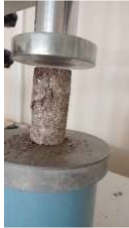
Şekil 39: 4. Optimizasyon Donma-Çözülme 3. Çevrim Serbest Basınç Dayanımı
