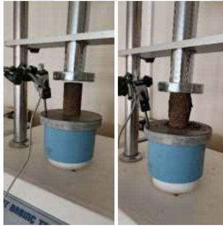
Şekil 46: 1. Optimizasyon Islatma 3 Günlük Serbest Basınç Dayanımı
