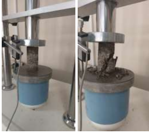
Şekil 40: 4. Optimizasyon Donma-Çözülme 6. Çevrim Serbest Basınç Dayanımı
