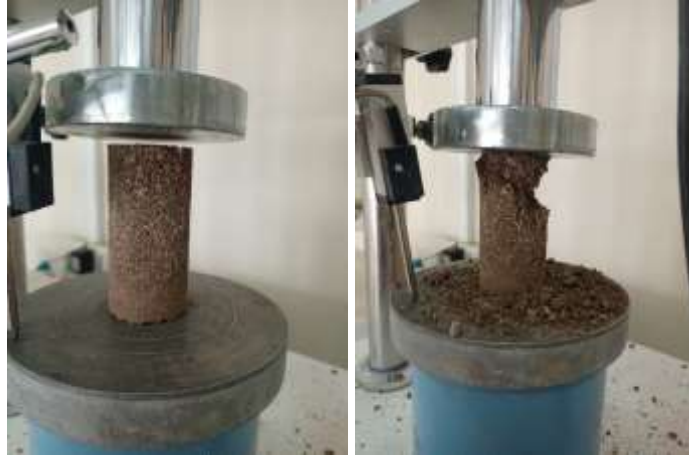
Şekil 23: 3. Optimizasyon 28 Günlük Serbest Basınç Dayanımı
