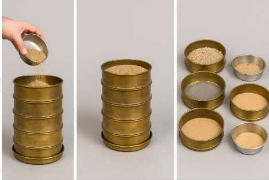
Şekil 10: Elek Analizi Uygulanışı
