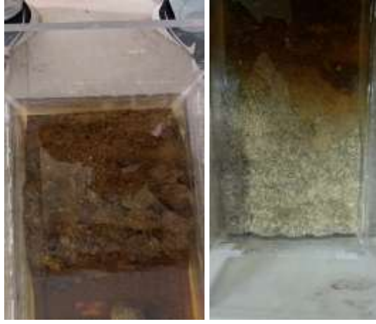
Şekil 50: 2. ve 3. Optimizasyon Islatma Serbest Basınç Dayanımı
