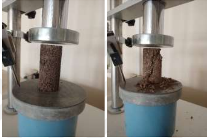
Şekil 35: 3. Optimizasyon Donma-Çözülme 3. Çevrim Serbest Basınç Dayanımı
