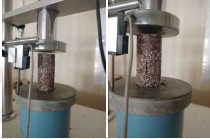
Şekil 21: 1. Optimizasyon 28 Günlük Serbest Basınç Dayanımı
