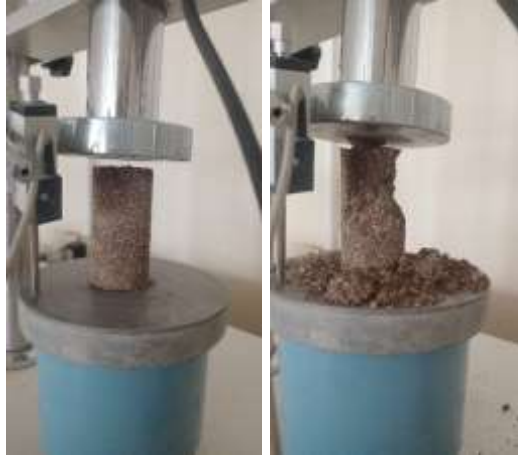
Şekil 37: 3. Optimizasyon Donma-Çözülme 9. Çevrim Serbest Basınç Dayanımı
