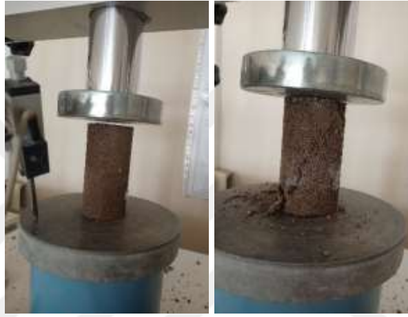
Şekil 51: 4. Optimizasyon Islatma 3 Günlük Serbest Basınç Dayanımı
