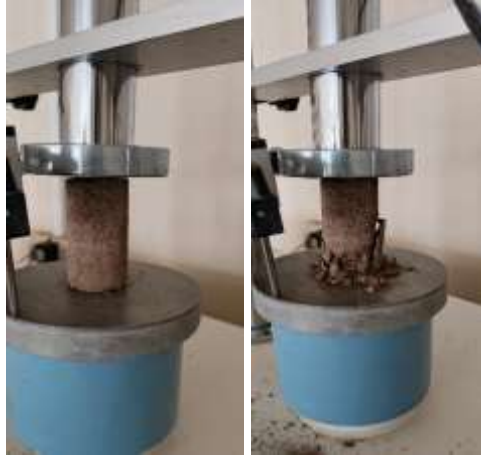
Şekil 34: 2. Optimizasyon Donma-Çözülme 12. Çevrim Serbest Basınç Dayanımı
