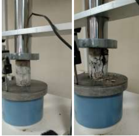
Şekil 30: 1. Optimizasyon Donma-Çözülme 12. Çevrim Serbest Basınç Dayanımı
