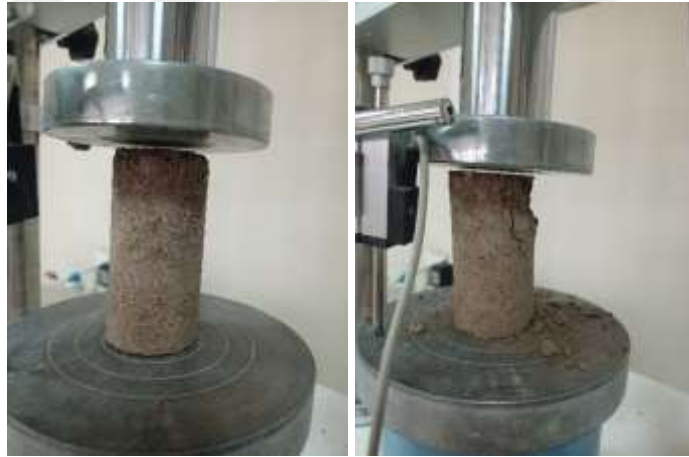
Şekil 22: 2. Optimizasyon 28 Günlük Serbest Basınç Dayanımı
