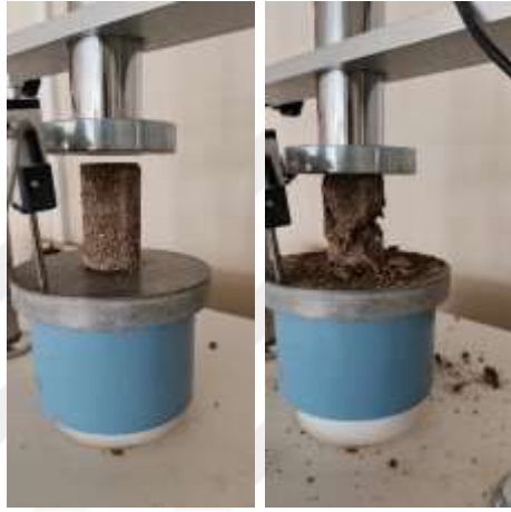
Şekil 38: 3. Optimizasyon Donma-Çözülme 12. Çevrim Serbest Basınç Dayanımı
