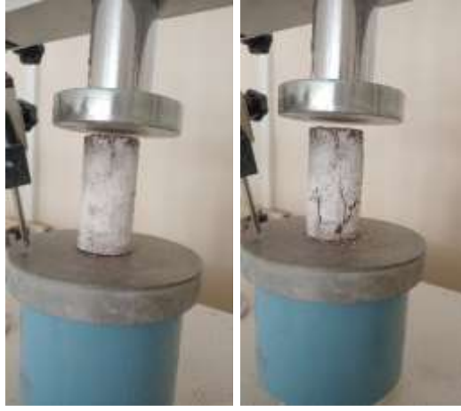
Şekil 28: 1. Optimizasyon Donma-Çözülme 6. Çevrim Serbest Basınç Dayanımı
