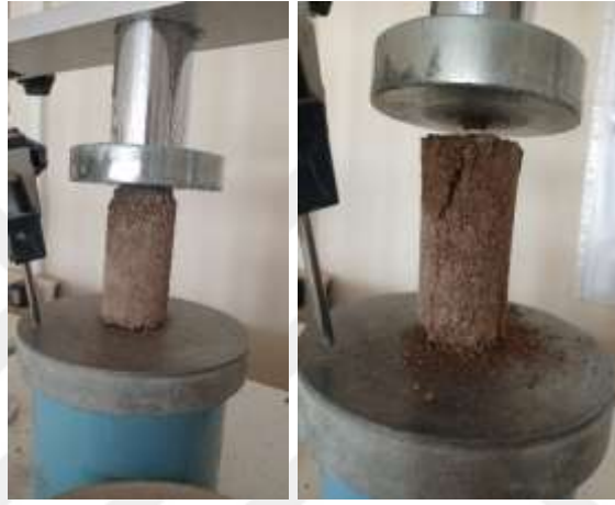
Şekil 32: 2. Optimizasyon Donma-Çözülme 6. Çevrim Serbest Basınç Dayanımı
