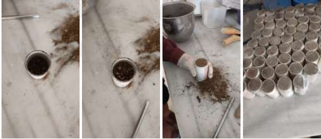
Şekil 19: Zemin Numuneleri Hazırlama Aşamaları
